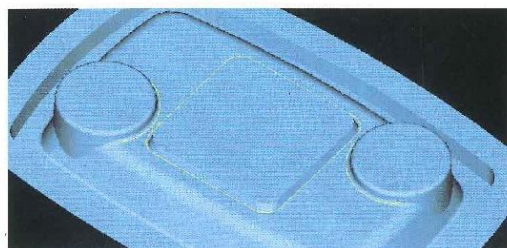
Fresado de Gorgantas Detecta y mecaniza las ranuras y los empalmes para una óptima preparación del HSC
