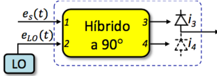
Figura 2. 1. Esquema de recepción coherente con híbrido de 90°. [1]
