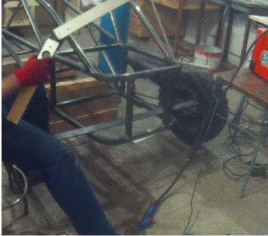
Figura 94: Posicionamiento de los anclajes de los trapecios
