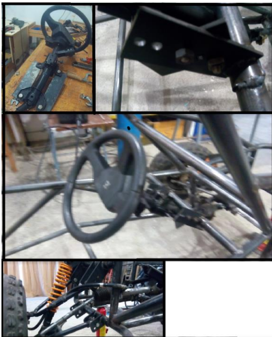
Figura 97: Construcción del soporte de la dirección
