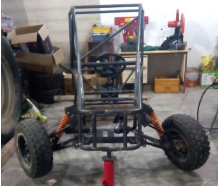
Figura 72: Comprobación del ratio de dirección.
