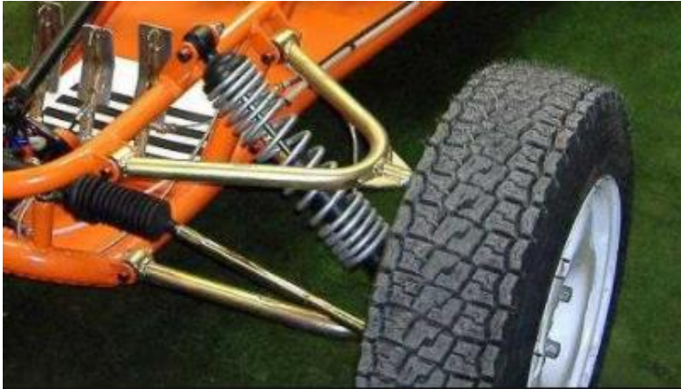
Figura 47: Suspensión de cuadrilátero articulado en un Buggy
