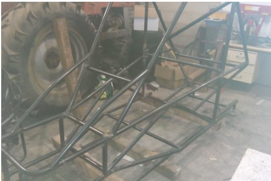
Figura 87: Punteo de la estructura final
