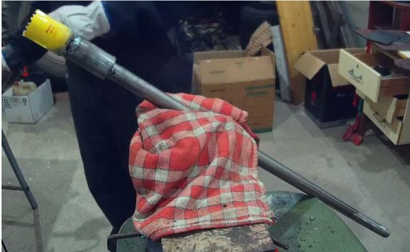
Figura 115: Fabricación del adaptador para la corona
