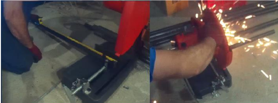
Figura 75: Corte de los perfiles
