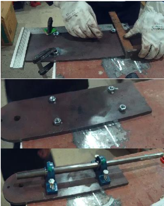
Figura 110: Fabricación de los soportes
