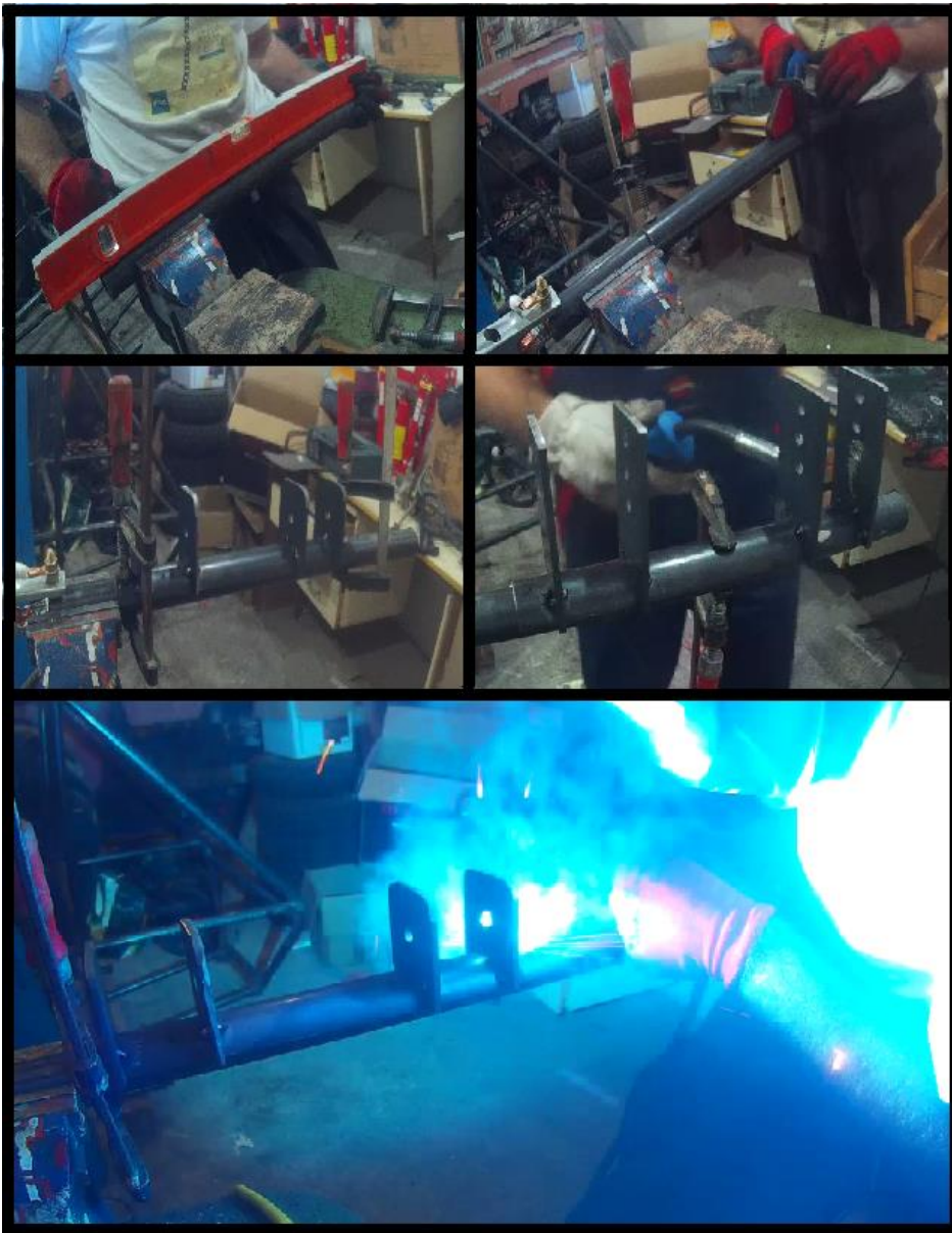
Figura 93: Proceso de construcción del soporte de las orejetas
