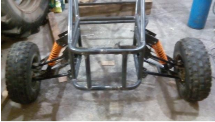
Figura 96: Posición final de la suspensión
