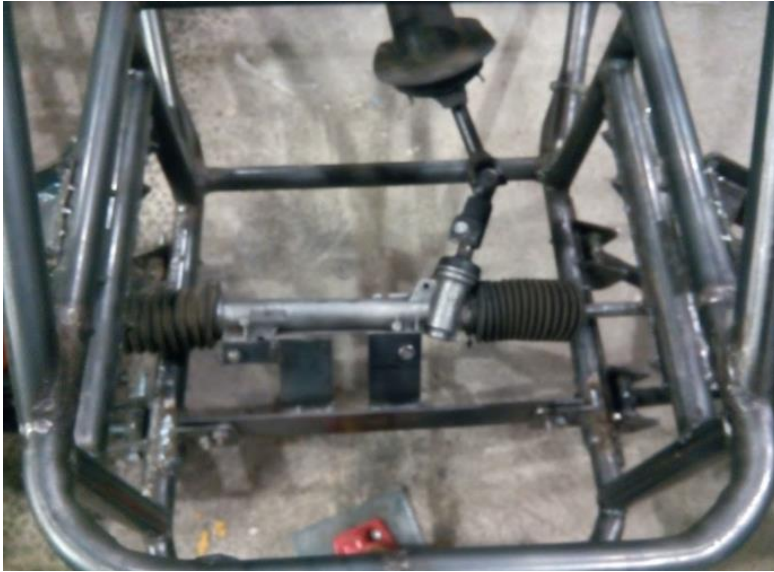
Figura 98: Construcción del soporte de la cremallera
