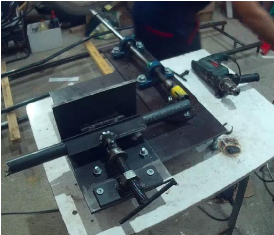
Figura 116: Tube notcher fabricación final
