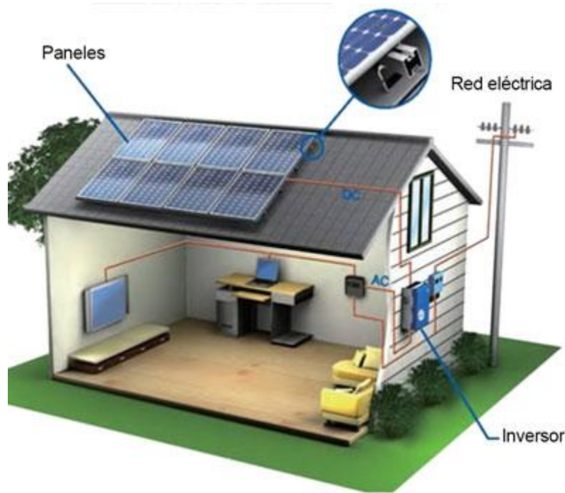
FOTO 13. Componentes de una instalación fotovoltaica conectada a red [18].
