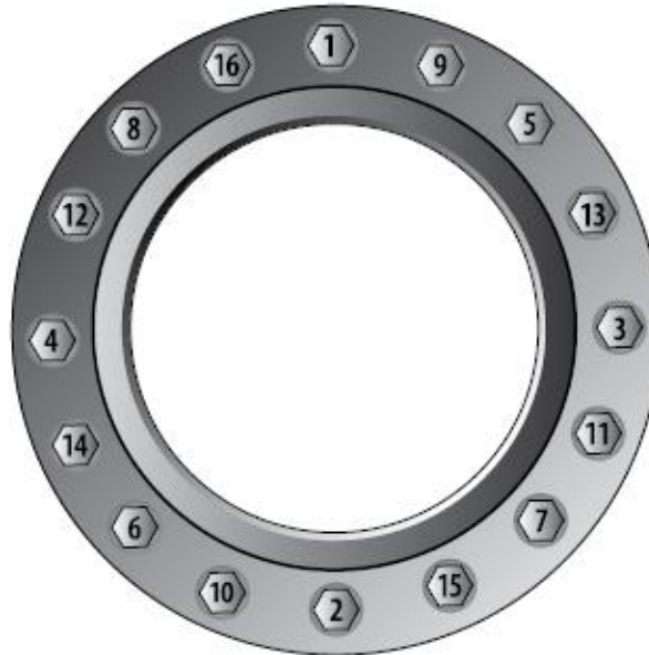
25. Guía de colocación de tornillos
