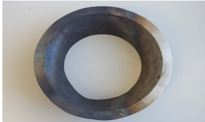
Fig. 44 Reconcentrador después de la prueba de desenfoque.
