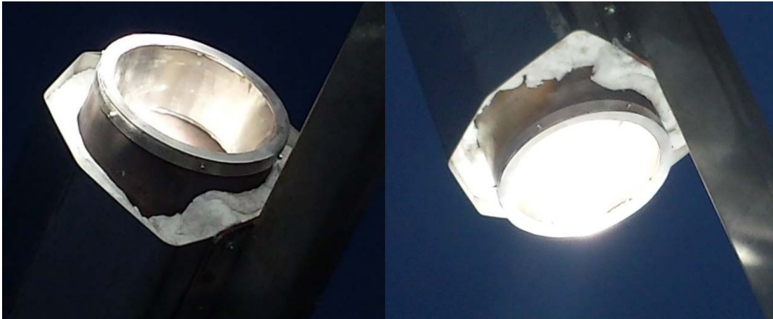
Fig. 45 A la izquierda se observa sistema desenfocado y sucio con aro. Mientras, a la derecha se muestra el sistema enfocado y limpio con aro.
