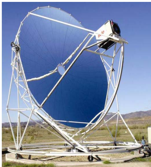
Fig. 27 Eurodish de 10kW, situado en la Plataforma Solar de Almería. (21)
