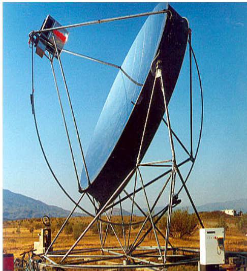
Fig. 13 Distal II, construido con membrana tensionada. (10)
