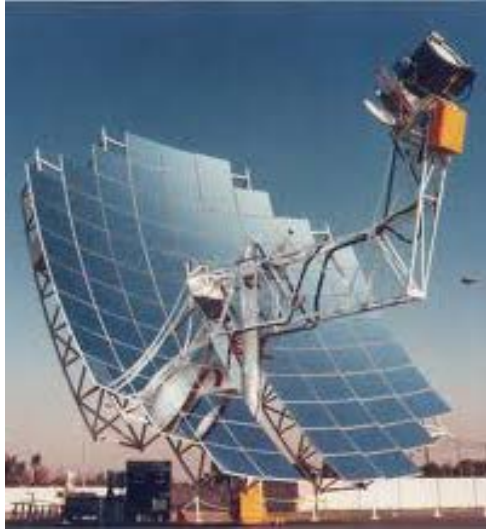
Fig. 12 Disco Stirling compuesto de pequeñas facetas de vidrio. (9)
