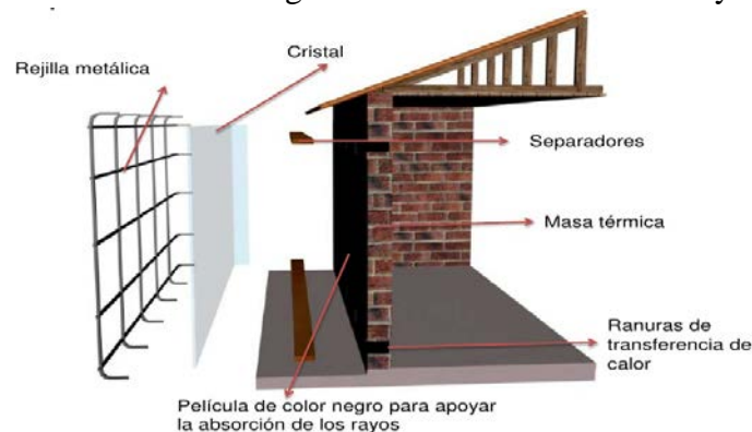
Fig. 1 Despiece de un muro Trombe. (2)
