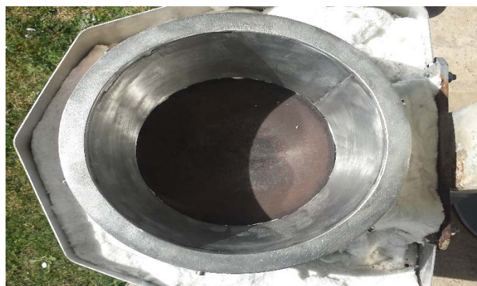
Fig. 41 Montaje del reconcentrador en el receptor.
