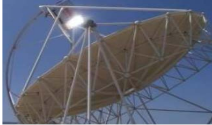
Fig. 10 Estructura tubular de un disco Stirling de 10 kW. (7)
