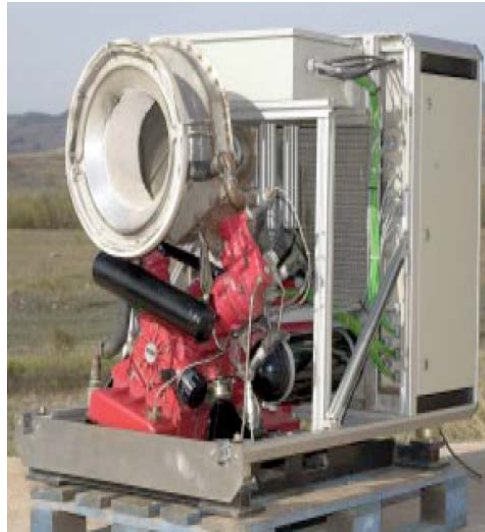
Fig. 28 Motor, del sistema eurodish, modelo SOLO 161 y su receptor. (4)
