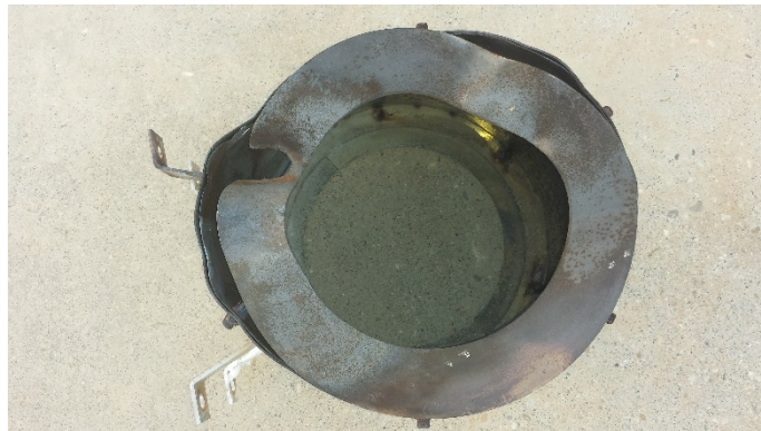
Fig. 43 Aro dañado por desenfoco del disco
