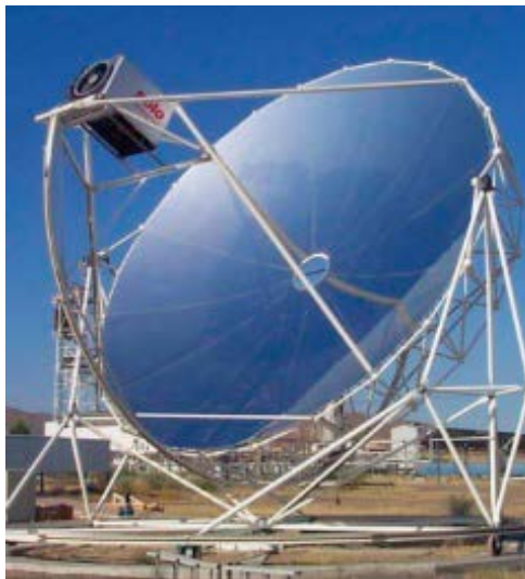
Fig. 11 Disco Stirling formado por facetas con forma parabólica. (8)
