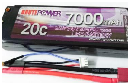
Figura 32. Celda2S Lipo con capacidad de 7000 mAh
