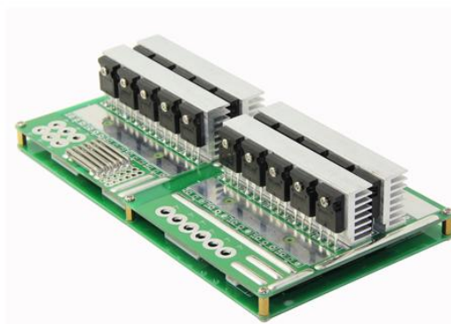
Figura 37. BMS instalado por cada rama de la batería
