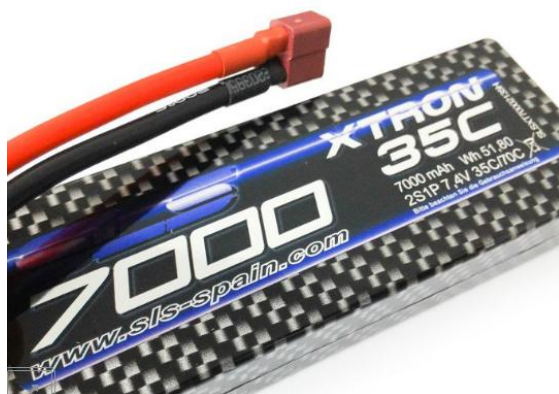
Figura 34. Pack de 7,4V y 7Ah (2S1P)
