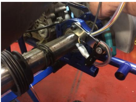
Figura 5. Sensor colocado en el eje trasero (no detectando el imán)
