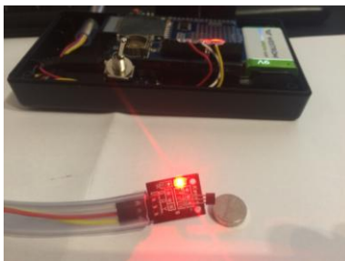
Figura 9. Sensor hall junto al imán, (detectando)
