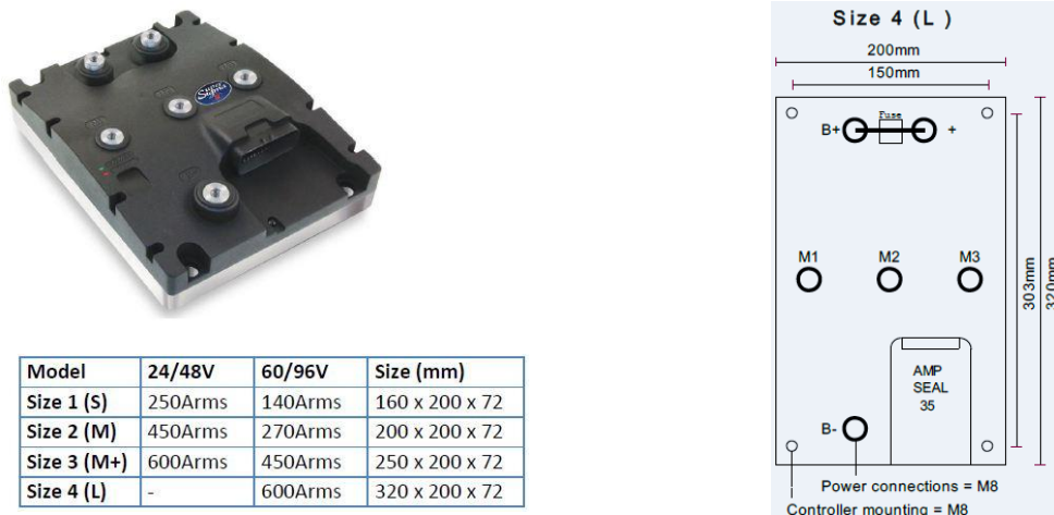
Figura 38. Dimensiones del controlador seleccionado (tamaño 4)
