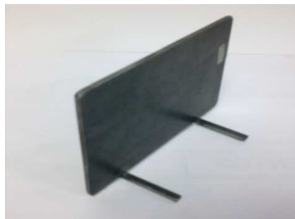
Acero con espesor de 4 mm , 350x100 mm
