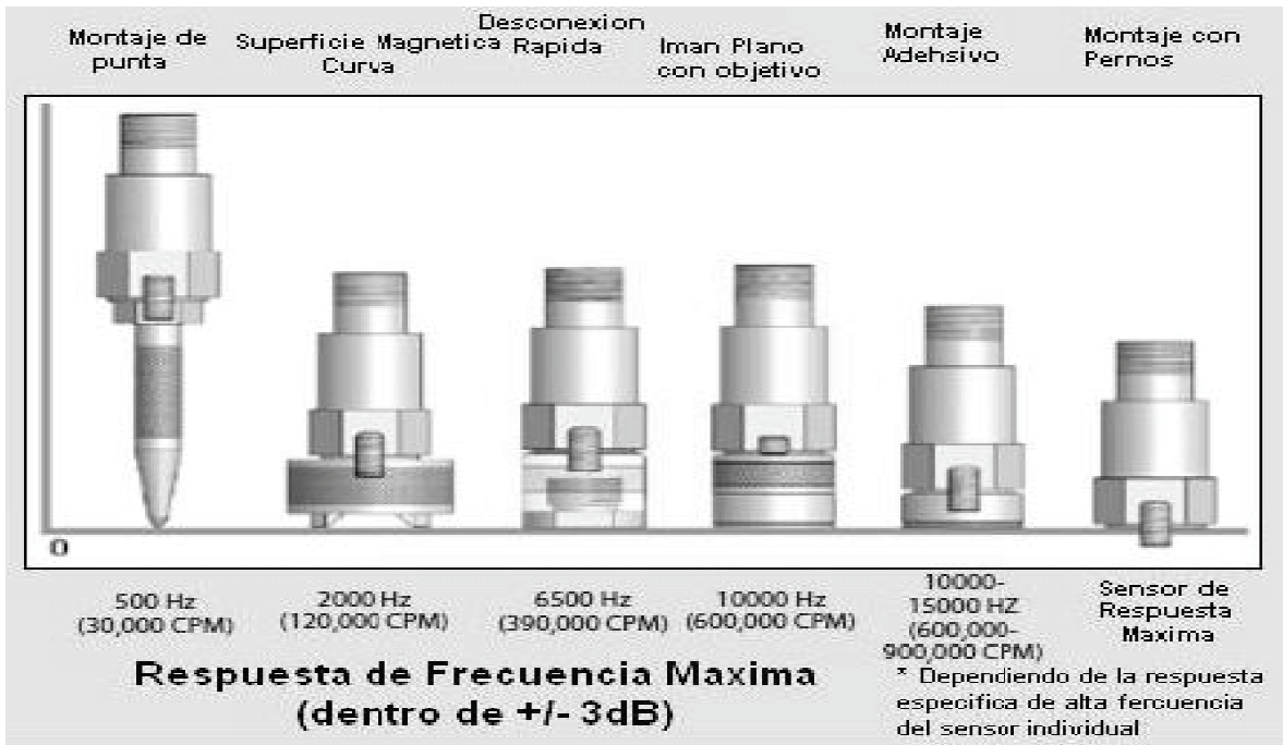
Figura 4.1.5: Montaje de un acelerómetro frecuencia máxima medible.
