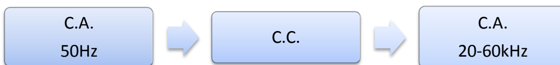
Ilustración 12. Esquema transformaciones energía eléctrica en CFL.
