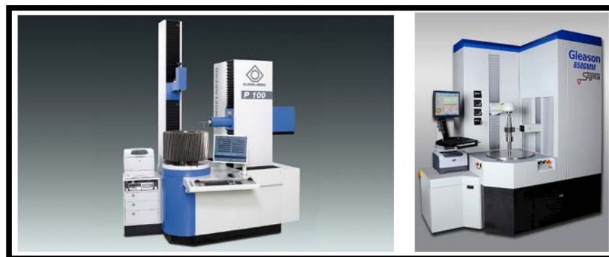
Figura 2 Maquinas de medida de engranajes por palpado continuo
