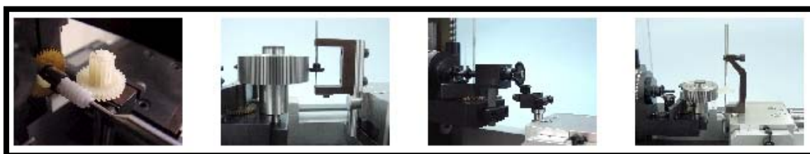
Figura 4 Ensayos de rodadura a un flanco y a dos flancos
