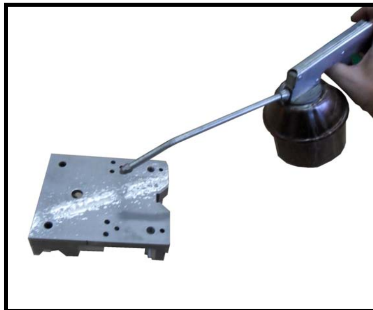
Figura 48 Engrase superficies mecanizadas
