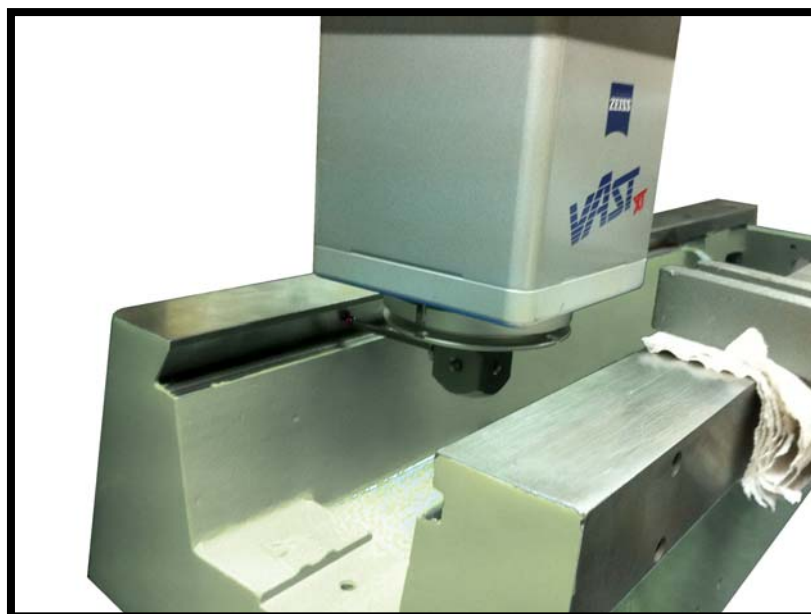
Figura 25 Medición de ángulo en MMC
