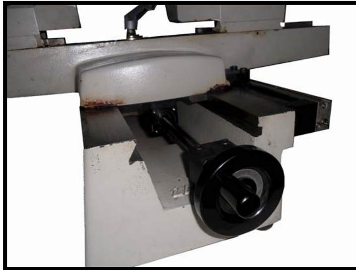
Figura 15 Detalle guías prismáticas bancada, husillo y volante
