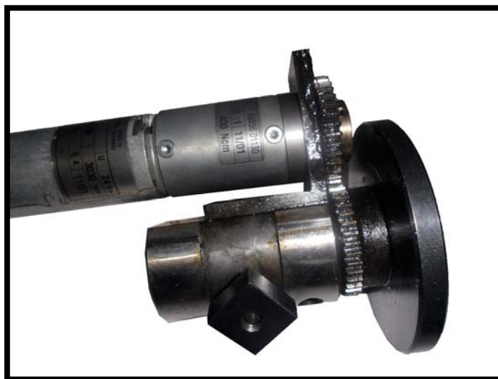
Figura 16 Sistema motriz con punto de arrastre
