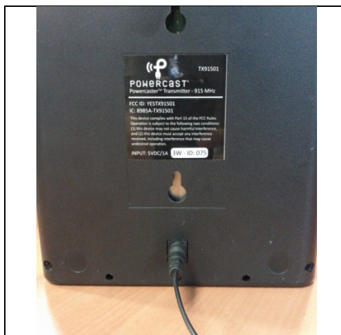
Conexión de la alimentación del emisor
