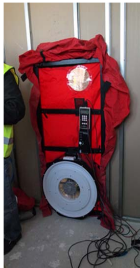
Imagen 5. Instalación de sistema de medida de infiltraciones en el espacio de ensayos
