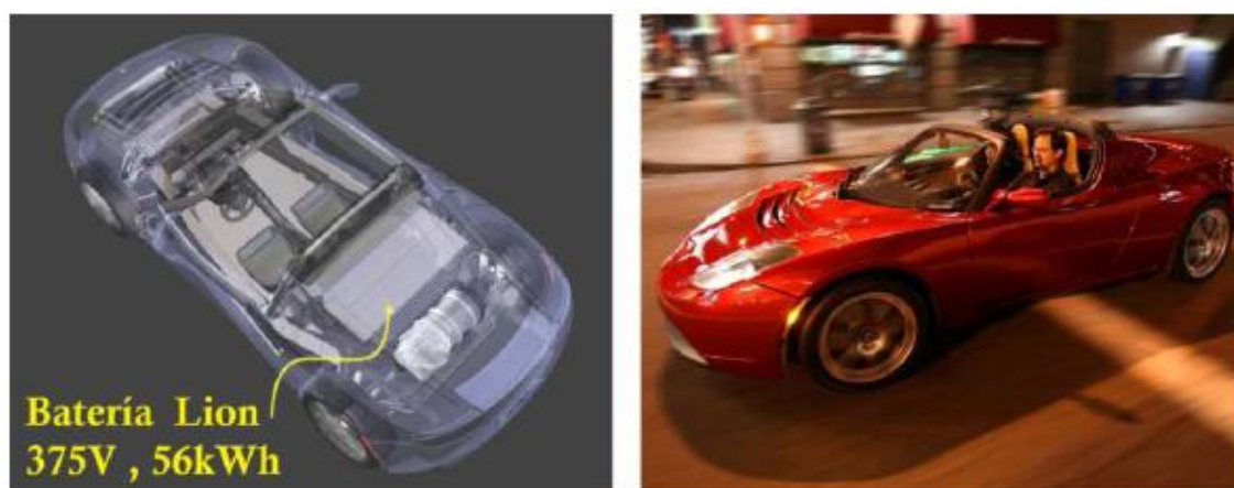
Figura: 3.3, Esquema y fotografía del Tesla Roadster, vehículo eléctrico impulsado por baterías de Ión-Litio.
