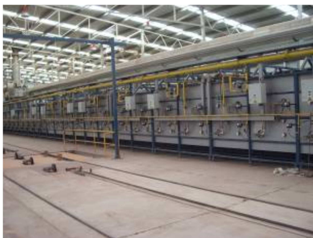
Figura 22. Zona de quemadores del horno túnel: calentamiento y horno.
