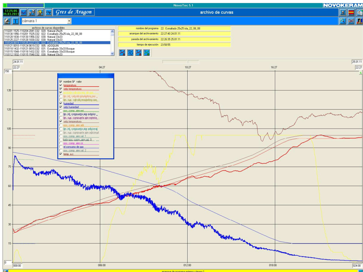
Figura 16. Curva de secado del formato 25x25 isla dentro de la cámara.
