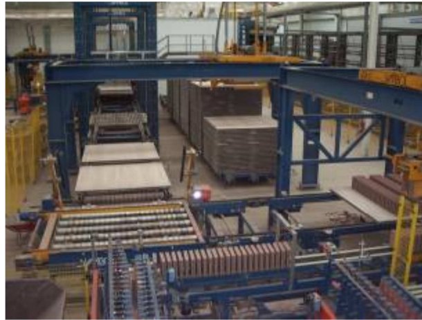
Figura 18. Zona de preparación de piezas para el esmaltado.
