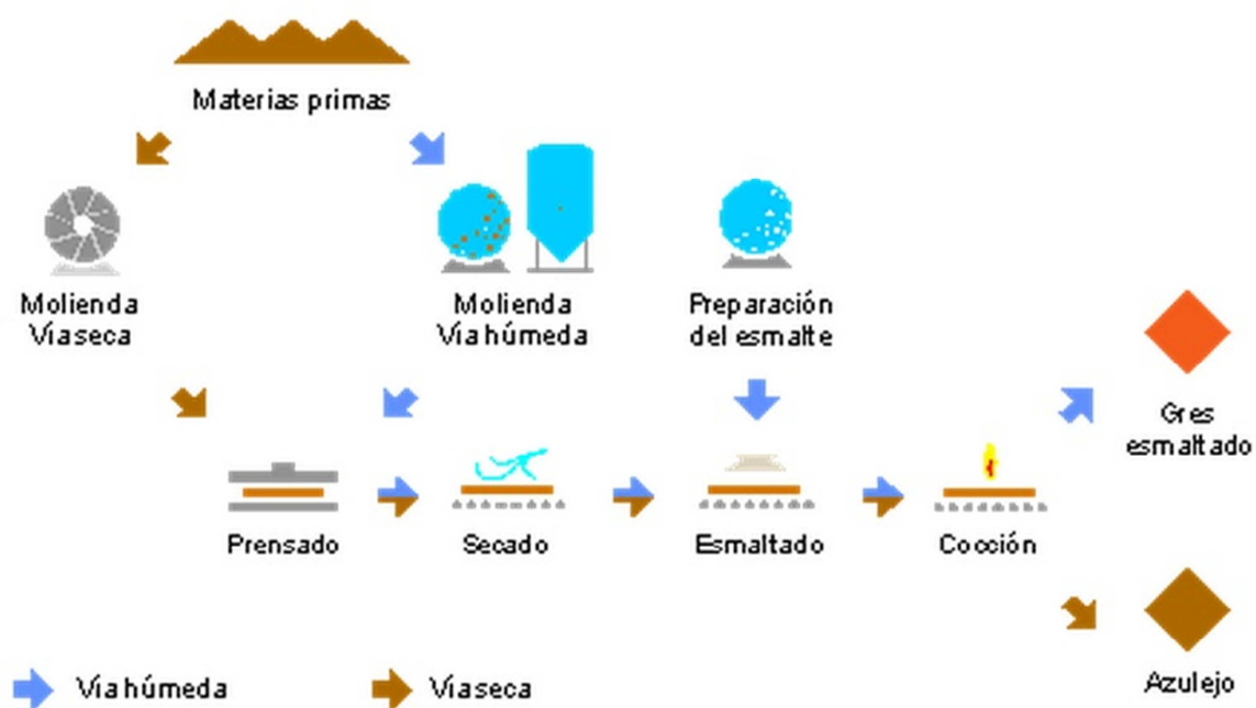
Figura 5. Esquema del proceso de fabricación de baldosas cerámicas.
