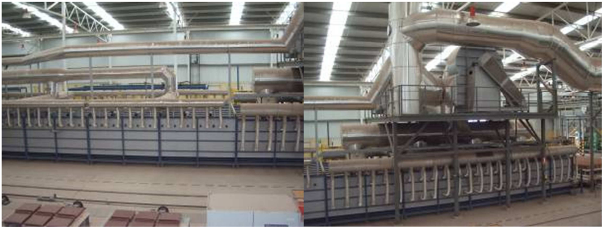
Figura 23. Zona de enfriamiento indirecto y final del horno túnel: toberas y chimenea para reuso del calor residual en secaderos.
