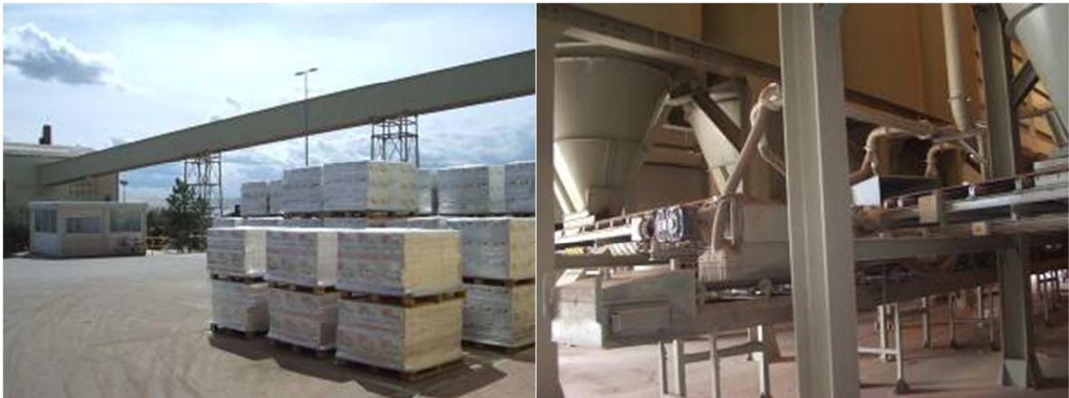
Figura 8. Alimentación por la cinta transportadora de la materia prima y de un silo de arcilla
