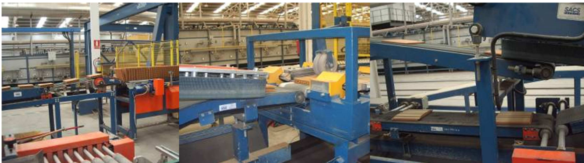
Figura 24. Zona de selección: colocación horizontal, corte de lapiceros y volteo de la 2ª fila.
