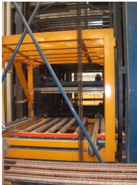
Figura12. Detalle de la cámara del destonificador de bandejas.
