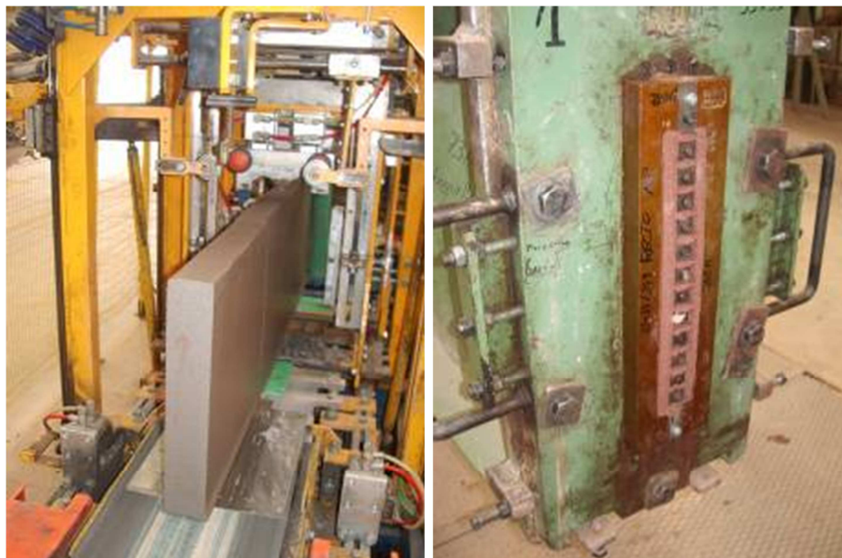
Figura 11. Detalle del molde de la extrusora y fabricación de lingote de barro para piezas especiales.
