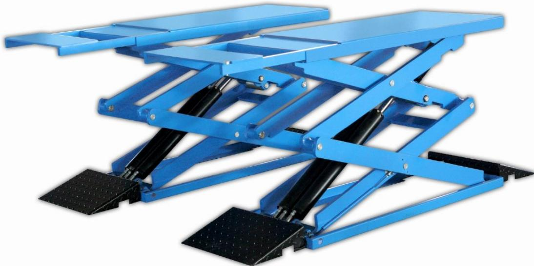
El principio de funcionamiento del elevador se basa en una estructura metálica que utiliza la geometría y funcionamiento de las tijeras para aumentar la distancia mediante la fuerza que será aplicada por dos cilindros hidráulicos.
