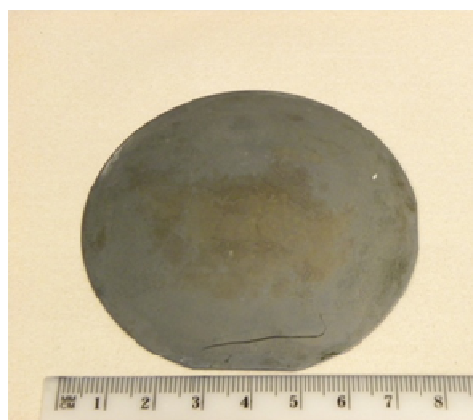
Figura 2.12: Síntesis de zeolita A a partir del gel A2 durante 7,5h a 90°C sobre oblea de SiO 2
