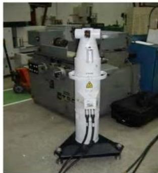
Figura 15.2 Láser Tracker "LEICA" modelo "LT-600" utilizado como LT3 durante el ensayo
