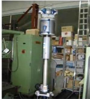
Figura 15.3 Láser Tracker “FARO” modelo “ION” utilizado como LT4 durante el ensayo
