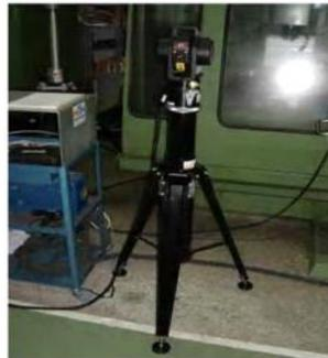
Figura 15.4 Láser Tracker “API” modelo “T3” utilizado como LT2 durante el ensayo.
