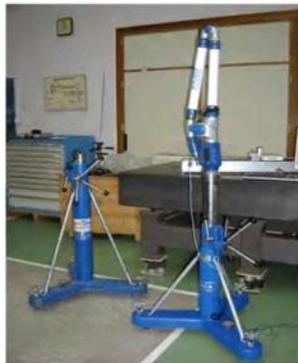
Figura 15.5 Brazo articulado de medición por coordenadas “FARO” modelo “PLATINUM” y trípodes supletorios utilizados para fijar el brazo y la lente retro reflectora.
