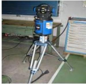
Figura 15.1 Láser Tracker "FARO" modelo "X" utilizado como LT1 durante el ensayo
