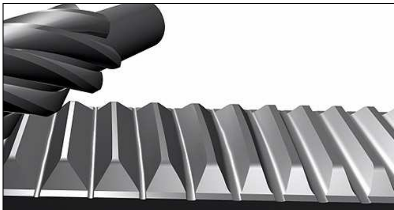
Fig.2.6. Cremallera y piñón con relación variable.
