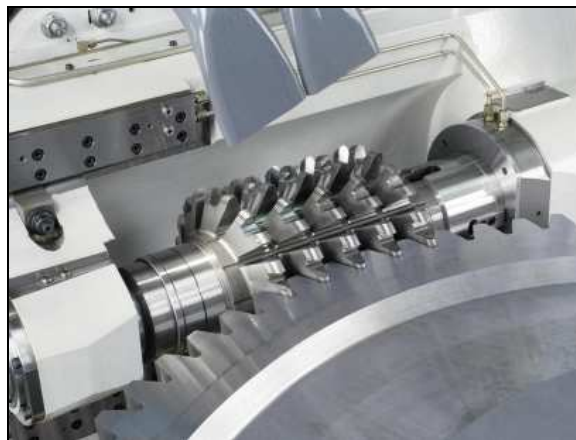
Fig.3.4. Generación con fresa madre (Gleason Cutting Tools) [20].
