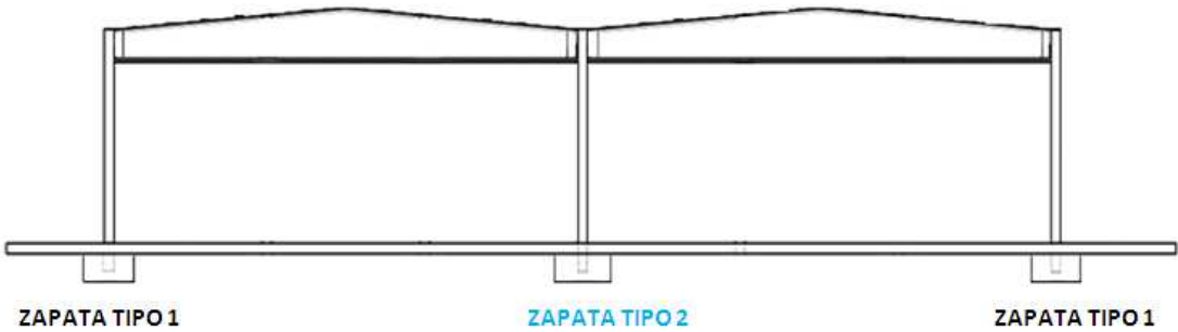
Figura 5.3.2 Gráfico del pórtico intermedio de la nave indicando el tipo de zapata.
