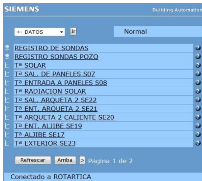
Figura A.3 Controlador web Siemens. Listado de sondas
