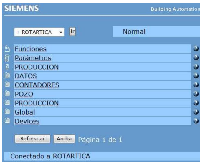
Figura A.2 Controlador web Siemens. Ventana de submenús
