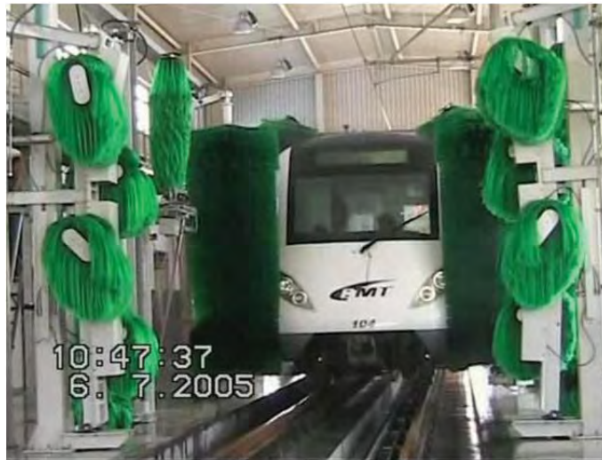
Figura A.34 - Túnel de lavado
