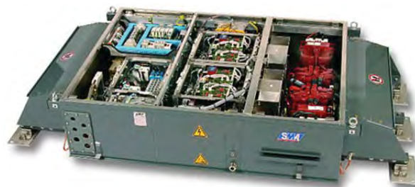
Figura A.24 – Convertidor de Auxiliares
