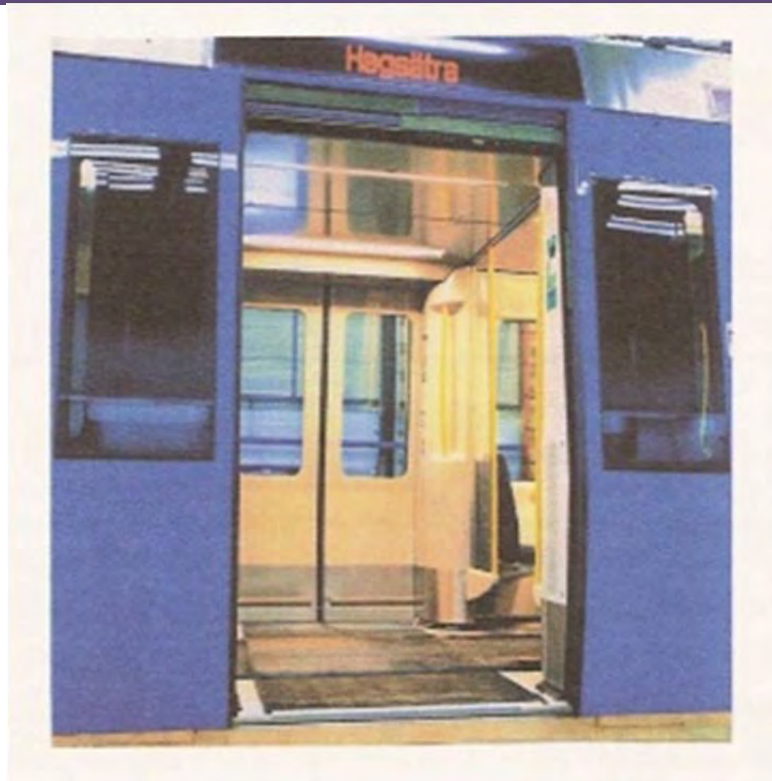
Figura A.13 - Sistema puertas de doble movimiento
