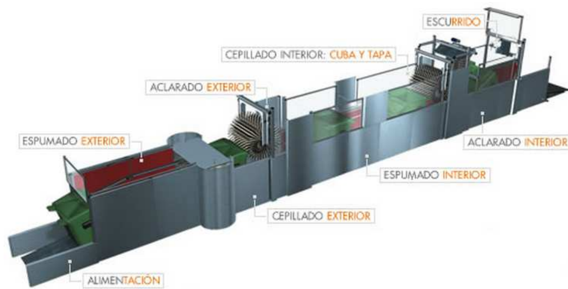
73. Esquema del túnel de lavado de contenedores [40]
