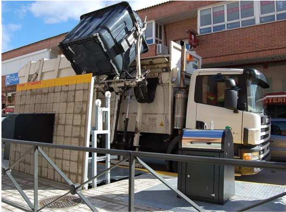
14. Soterrado para carga lateral [15]
