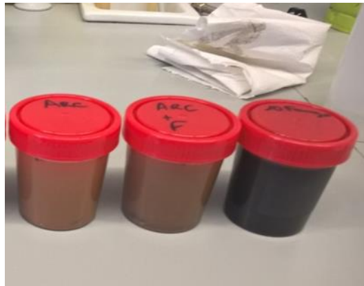
Figura 6.6: Suspensión inicial de las muestras sólidas tras el pretratamiento
