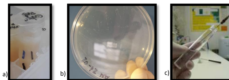
Figura 3.8: Etapas de la fortificación. a) Cepa de E.faecium . b) Placa con un cultivo joven y puro. c) Inoculación en tubo con suero fisiológico
