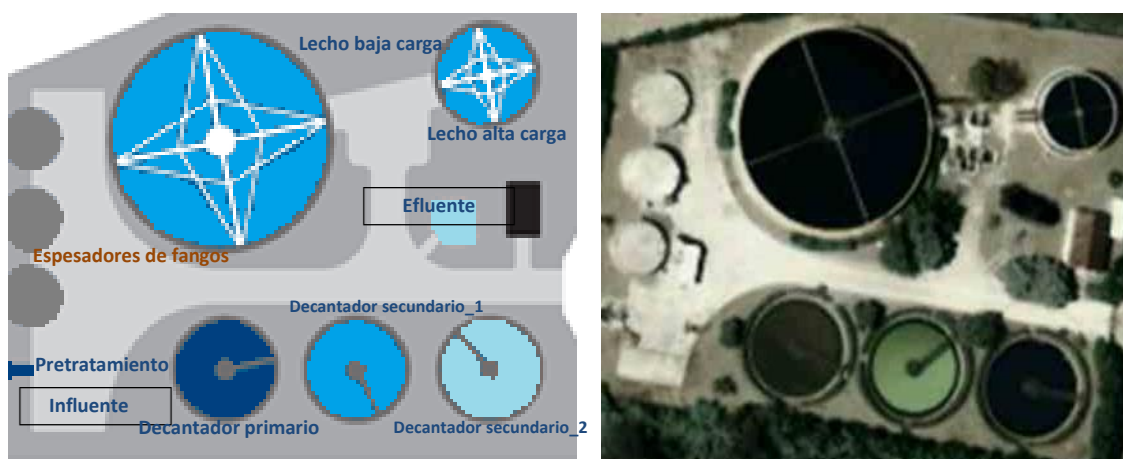
Figura 4.1: Dibujo esquemático de la EDAR 1 y vista real
