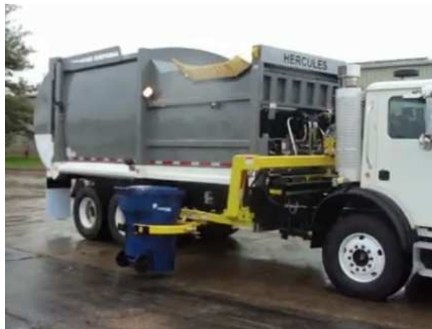
Figura 23: movimiento de retorno del contenedor al suelo
