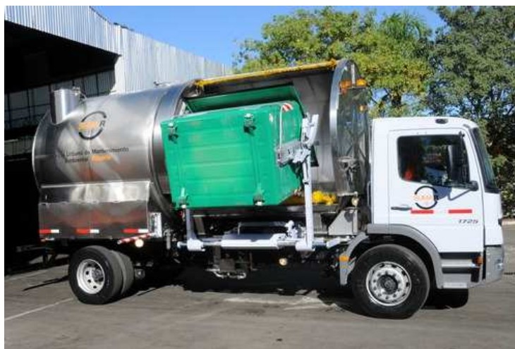
Figura 2: Sistema recolector lateral brazo doble
