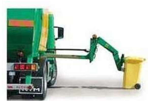
Figura 5: Sistema recolector lateral mono brazo
