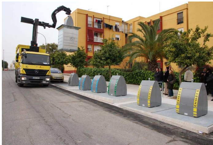
Figura 4: Sistema recolector bilateral
