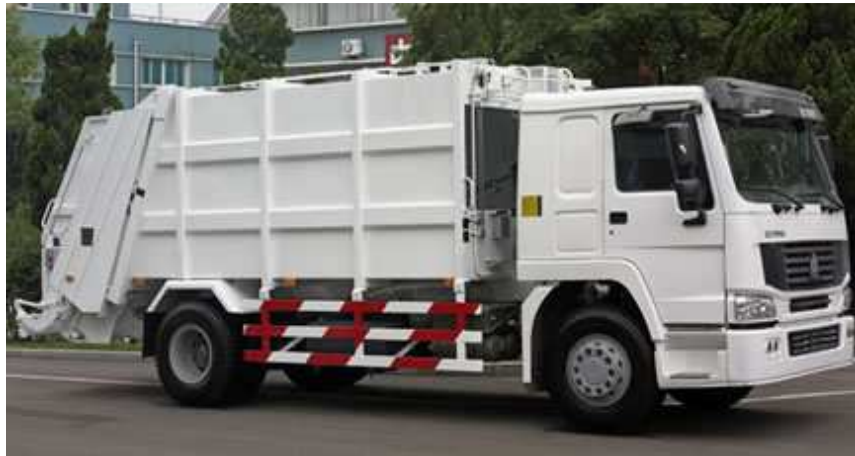
Figura 1: Sistema recolector trasero
