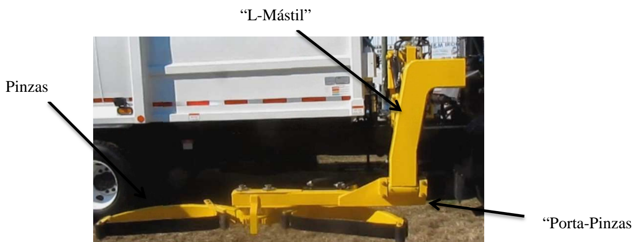
Figura 10: Imagen de la "Pinza", "Porta-pinzas" y "L-Mástil"
