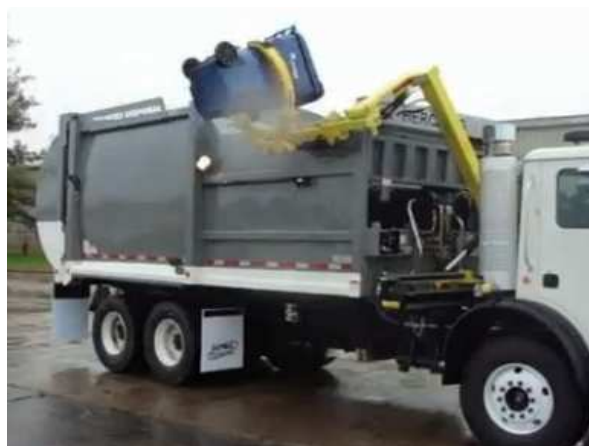
Figura 20: situación con el contenedor elevado, antes del vaciado
