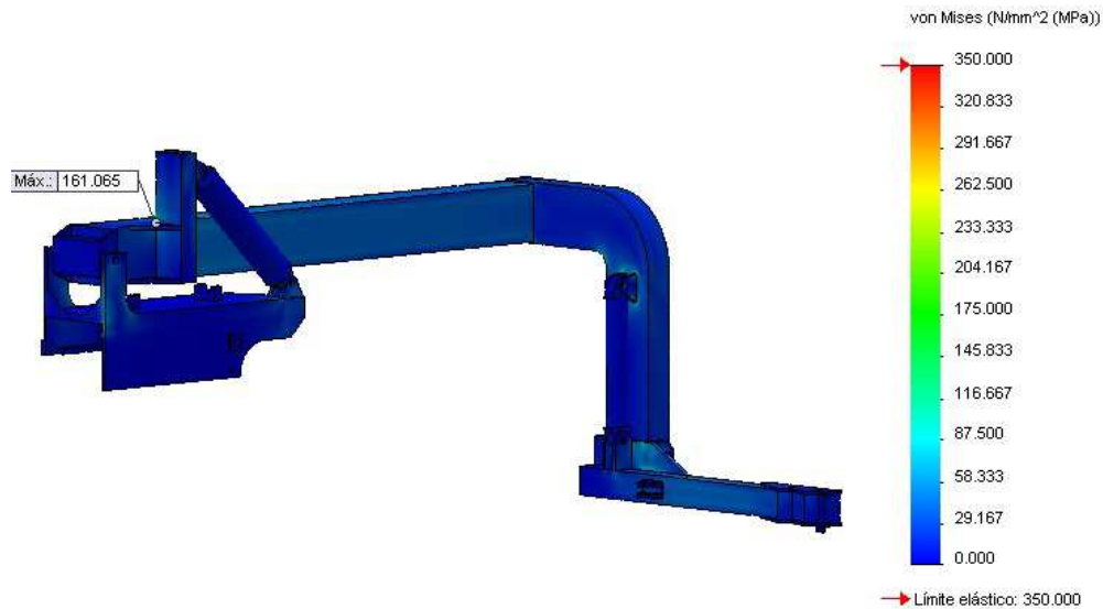
Figura 106: Distribución de Tensión Von Mises del ensamblaje optimizado
