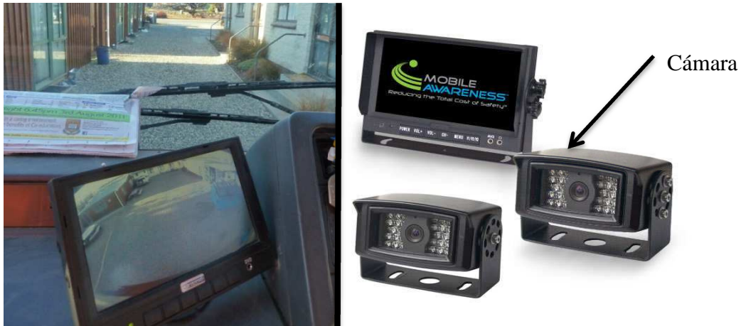
Figura 7: Sistema visión posición grúa-basura
