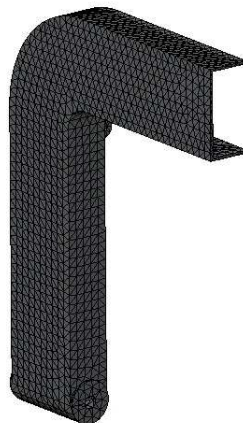
Figura 78: Ejemplo de pieza mallada
