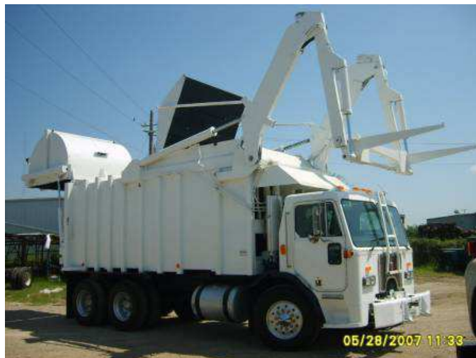
Figura 3: Sistema recolector frontal
