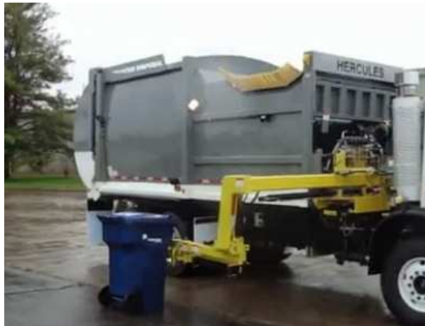
Figura 24: apertura de pinzas para depositar el contenedor
