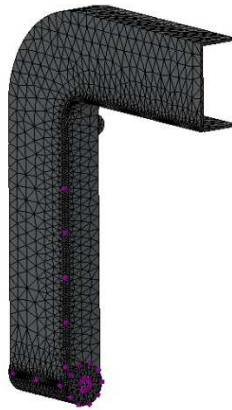
Figura 82: Ejemplo malla con control de malla en arista
