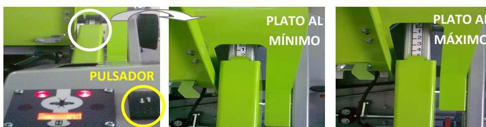
Fig.4.26 Pulsador en el panel del mando del cortacésped y posición máx./mín. del indicador de altura del plato de corte actualmente
