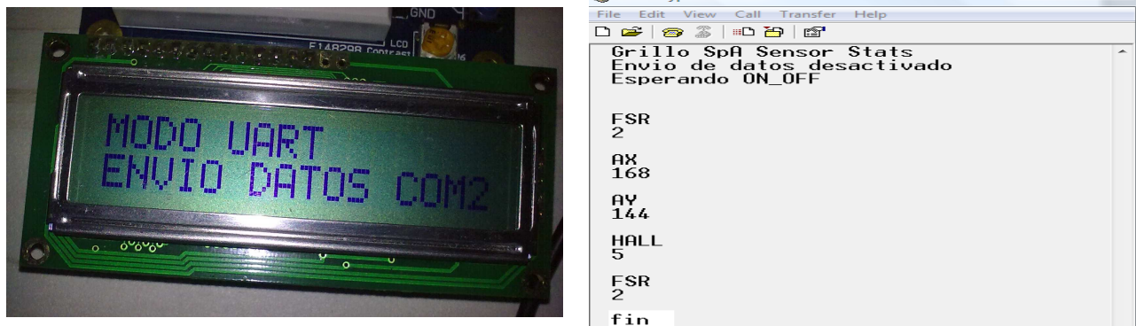
Fig. 4.100. Confirmación en LCD y datos en el hiperterminal
