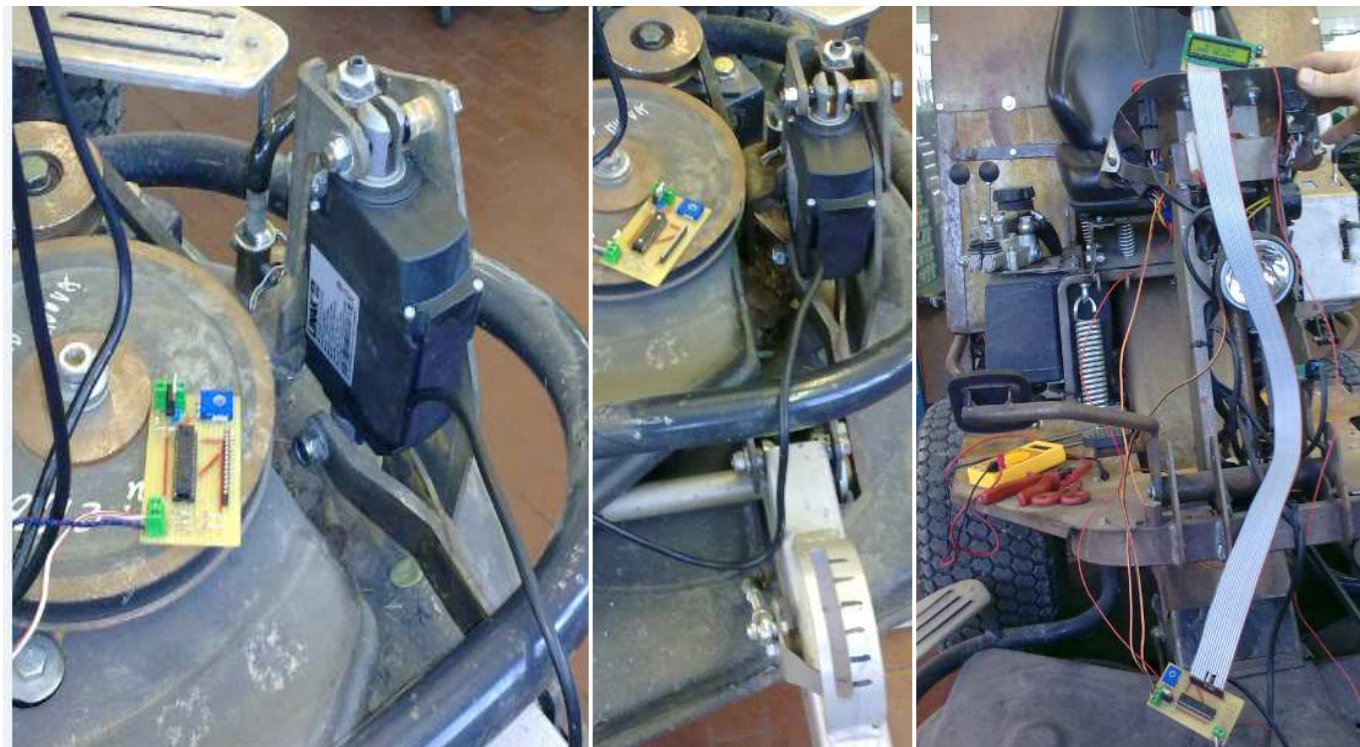
Fig. 4.41 Montaje del subsistema sobre la máquina para la realización de los test de funcionamiento
