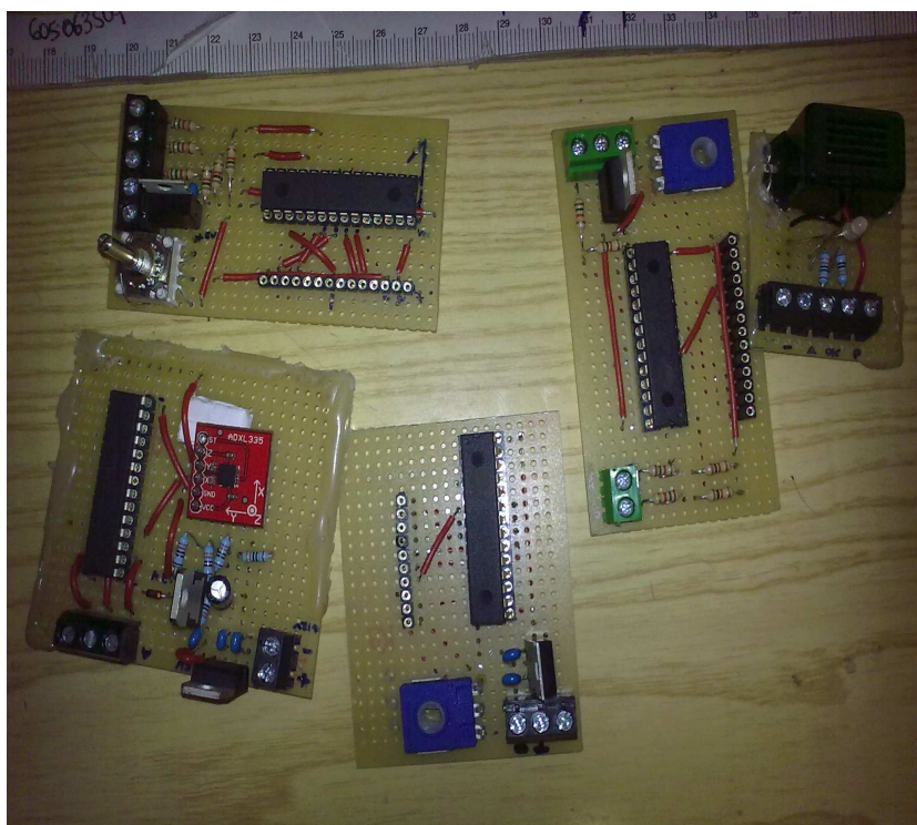
Fig 4.1 Algunos de los prototipos realizados sobre placa de puntos
