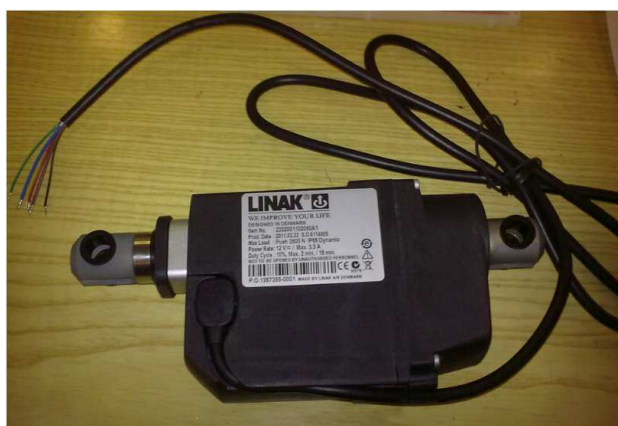
Fig.4.25 Actuador LINAK LA23
