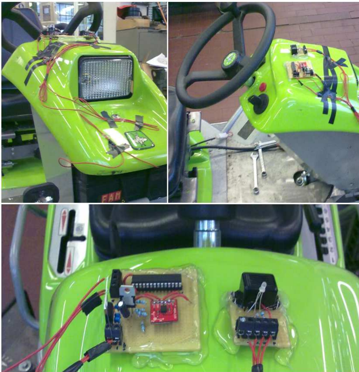
Fig 4.21 Montaje del subsistema sobre la máquina para la realización de los test de funcionamiento
