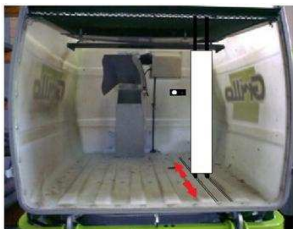
Fig. 4.48 Recreación del montaje del sensor GP2D12 en el cesto del cortacésped
