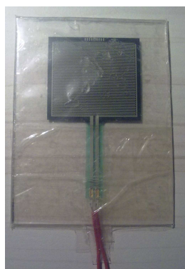
Fig 4.64 FSR protegido para realizar las pruebas sobre la máquina
