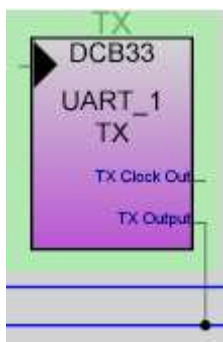
Fig. 3.73. Bloque Transmisor en el editor de dispositivos en PSoC
