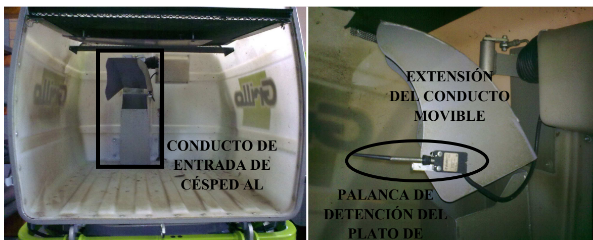
Fig 4. 43 Cesto de recogida y palanca de detención de las cuchillas del plato de corte
