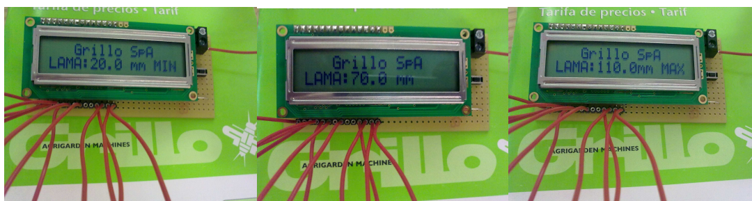
Fig. 4.42 Capturas del LCD en la realización de las simulaciones previas al montaje sobre la máquina
