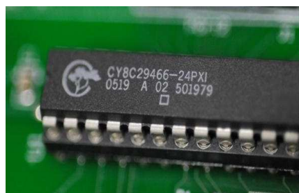
Fig. 3.5 Detalle del PSoC CY8C29466-24PXI
