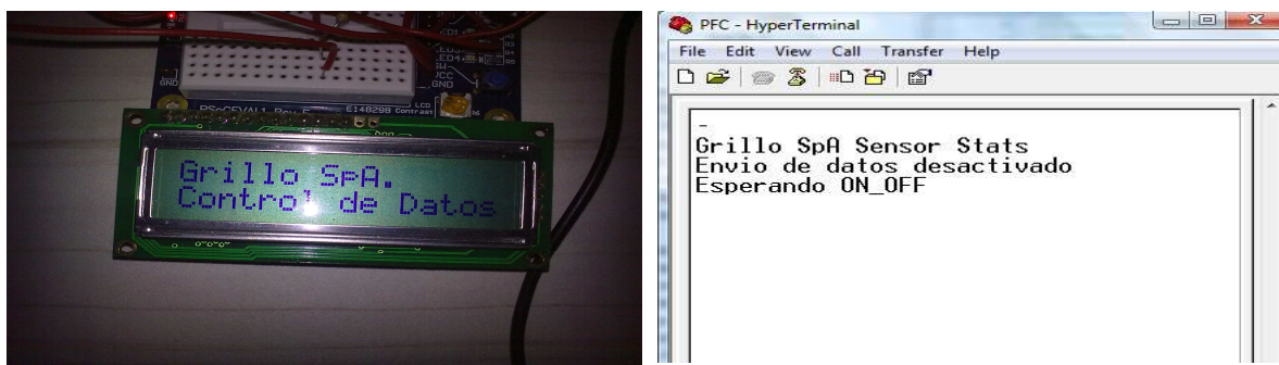
Fig. 4.98. Mensajes de inicio en LCD e Hiperterminal
