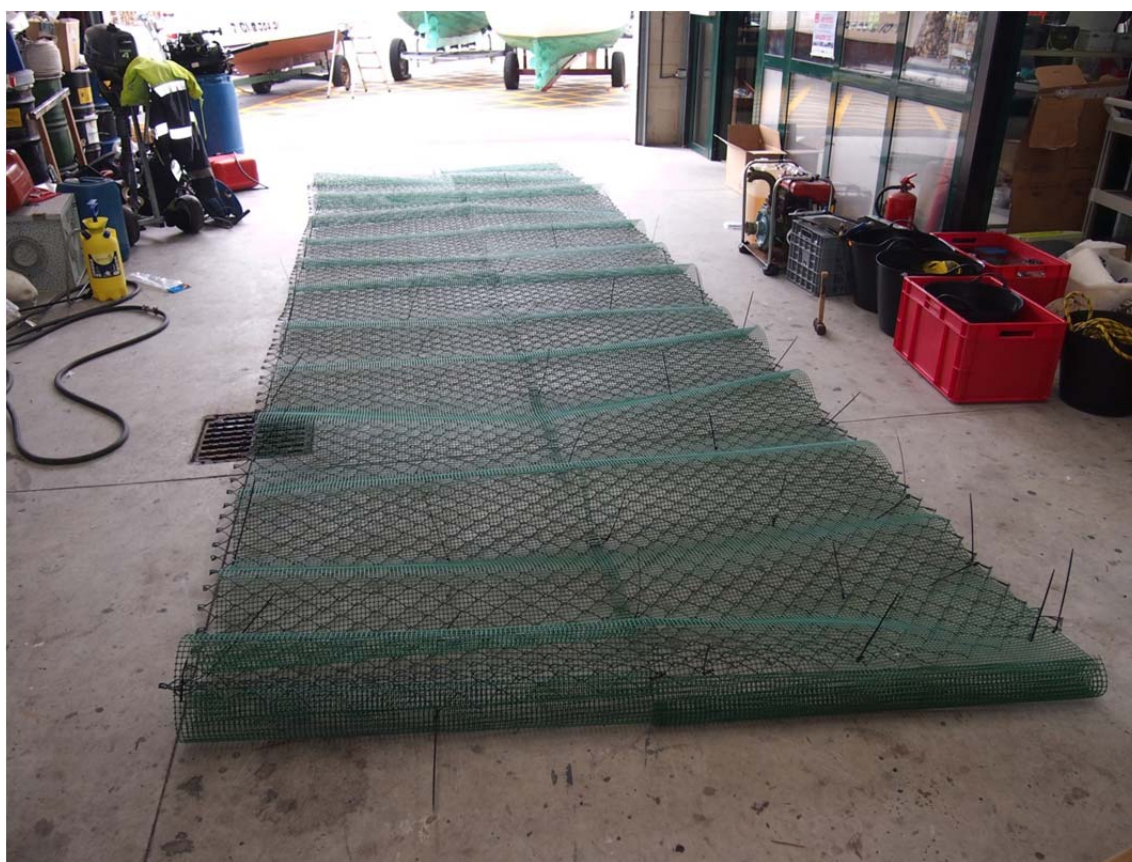
Trampa de arena en base de malla tridimensional. Fot: MSC.
