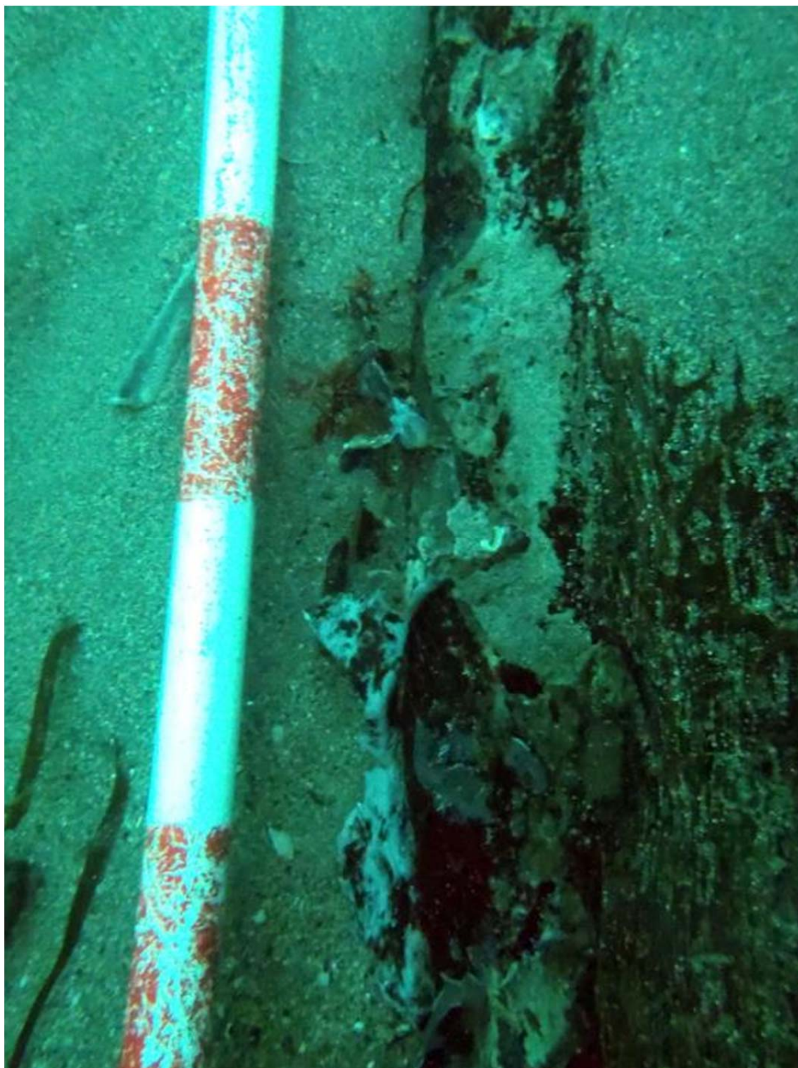
Entre el jalón y la madera del costado, se aprecia la fina lámina de plomo que constituye el forro de plomo del casco. Fot: MSC.
