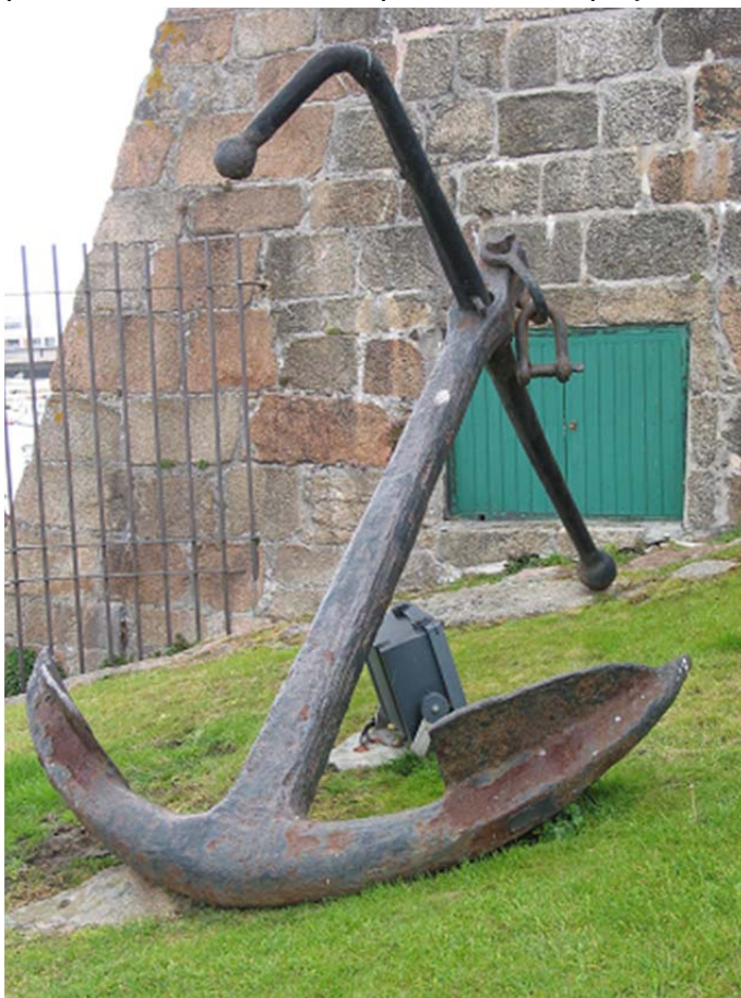
Ancla tipo almirantazgo, de hierro fundido, recuperada del puerto de La Coruña. Museo Arqueológico de San Antón. Fot: MSC.
