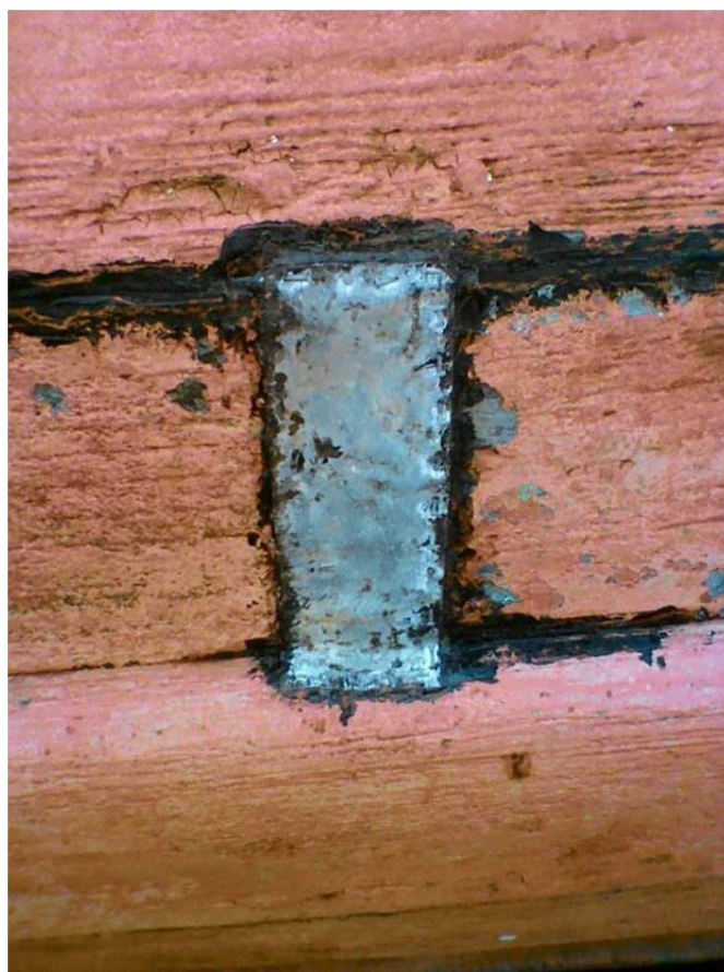
Lámina de plomo empleada en la reparación contemporánea del buque Hidria, último vapor español en servicio. Fot: gentileza de María José Otero Castro.
