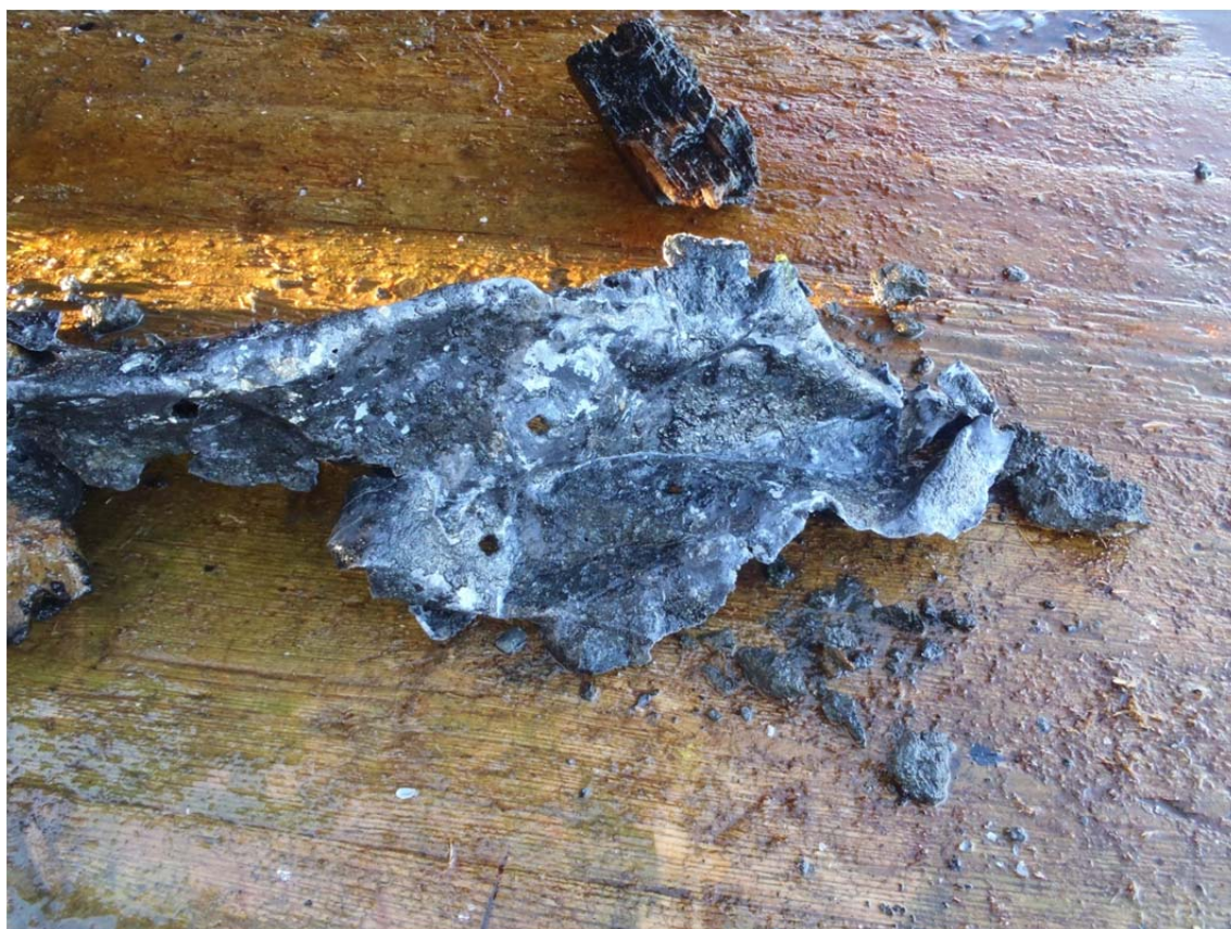
Fragmento de forro de plomo procedente de la ría de Ribadeo. Se aprecian los orificios de sección cuadrada dejados por los clavos que la fijaban al casco de madera. Fot: MSC
