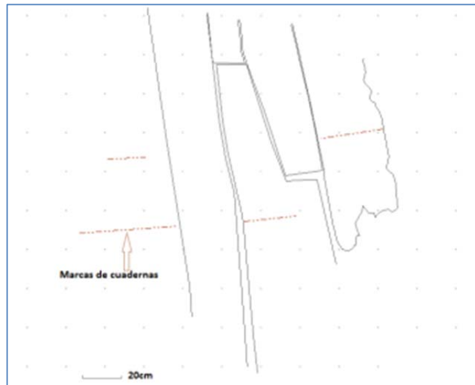
Esquema del ensamblaje de las tracas del costado del pecio de Ribadeo.
