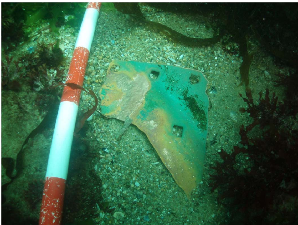
Fragmento del forro de cobre del vapor británico Geat Liverpool, 1846. Se aprecian las huellas de la clazón, cuadrada, que asimismo debía de ser de cobre. Fot: MSC.
