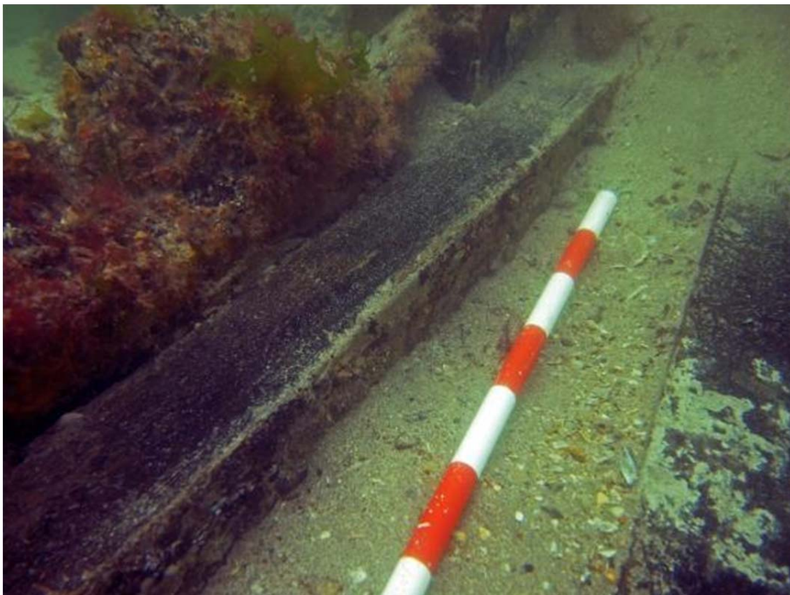
Forro del costado de estribor. A la izquierda se aprecian los restos de cuaderna a los que están adosados. A la derecha asoma una traca del costado desprendida. El espesor de la madera y la buena factura muestran una esmerada construcción. Fot: MSC.
