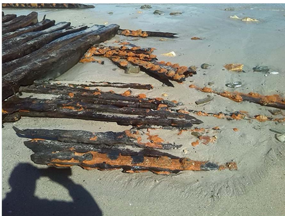
Pecio de Remior. Se aprecia la clavazón de hierro y el tingladillo sobre la cuaderna a la izquierda. Archivo, fotógrafo desconocido.
