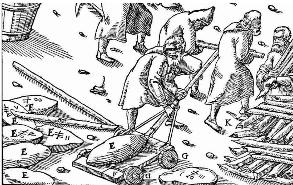
Lingotes de plomo naviformes (E). Repárese en las marcas inscritas sobre la parte plana de los mismos muy similares a las de los lingotes de punta Restelos y Carballeira, aparentemente se trata de indicaciones relativas al fundidor y a su peso. (Agricola 2011).
