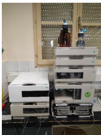
Figura 10: HPLC-DAD Agilent-HP 110 Series utilizado para la identificación y cuantificación de lipopéptidos.
