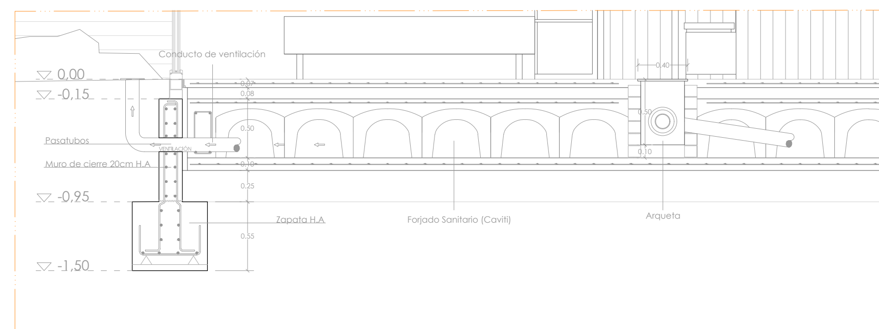
FS.2_Ventilación forjado sanitario tipo Caviti E:1/30
