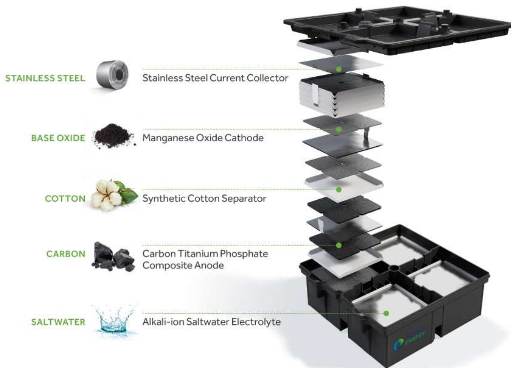
Figura 29 composición de la batería de electrolito de Na Fuente Aquion Energy
