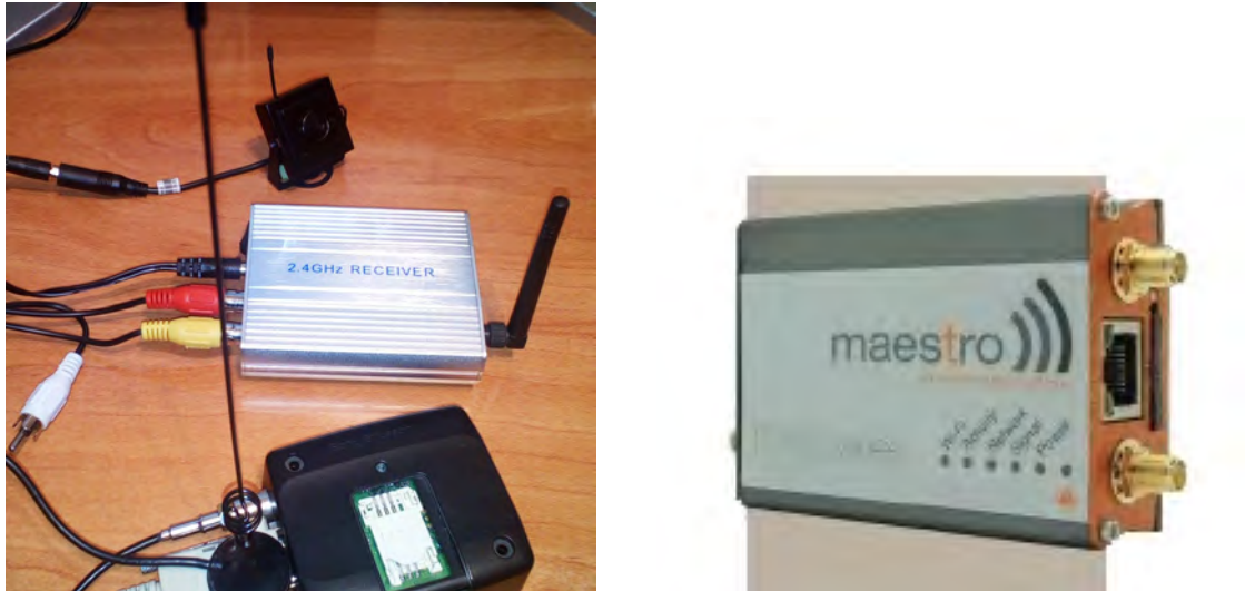
Figura 5.11: Cámara con transceptor incluido, transceptor IP Lan y router 3G/4G
