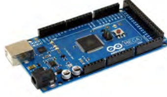
Figura 4.4: Equipo de control. Microcontrolador Arduino MEGA
