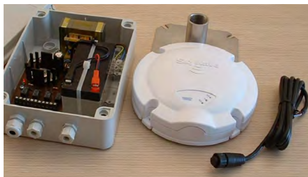
Figura 4.11: Composición del transmisor satelital DMR-800D completo
