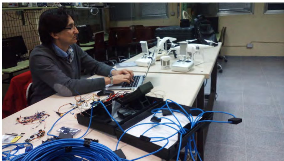
Figura 5.5: Ensayo con 5 sensores de la Red de sensores de impacto
