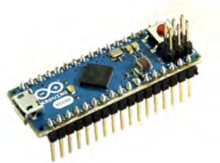
Figura 4.9: Sensor de impacto. Microcontrolador Arduino Micro
