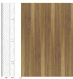
Aislante (MW) de lana mineral (tipo URSA Terra no hidrófilo y sin recubrimientos) de 8cm de espesor con una conductividad térmica de  $0,038 \text{ W/mK}$  y resistencia de  $2,37 \text{ m}^2\text{K/W}$ . Barrera de vapor de polietileno tipo 'rothoblaas barrier' 100 de 0,1mm espesor. Acabado interior de friso machihembrado de madera de abeto tipo rústico con acabado en "barniz satinado miel", de dimensiones  $9,5 \times 480 \times 1,7 \text{ cm}$ .
