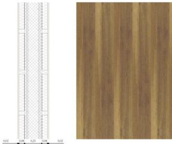
A ambos lados del mismo se dispone: aislante (MW) de lana mineral (tipo URSA Terra no hidrófilo y sin recubrimientos) de 8cm de espesor con una conductividad térmica de 0,038W/mK y resistencia de 2,37m<sup>2</sup>K/W. Acabado interior de friso machihembrado de madera de abeto tipo rústico con acabado en “barniz satinado miel”, de dimensiones 9,5x480x1,7cm.
