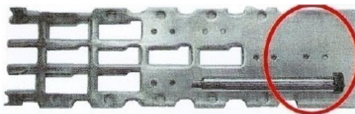
Detalle de banda progresiva con rotura de punzón.
