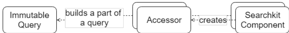
Figura 50. Relación entre la Immutable Query , los Accessor y los Component
