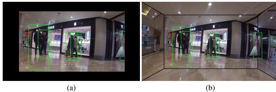
Figura 5.2: Resultados de la proyección del video en las gafas: (a) Toda la imagen se proyecta en la cara frontal del cubo 3D que envuelve la escena; (b) La imagen se divide en secciones que se proyectan en la cara frontal y en las laterales del cubo.
