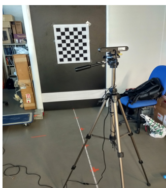
Figura 3.2: Detalle de la estación de calibración de las cámaras. Además de la cámara en el trípode, se ve el plano dominante (puerta) con el patrón utilizado para la calibración de las cámaras, y las marcas en el suelo correspondientes a las diferentes distancias relativas con respecto al plano dominante en la escena.
