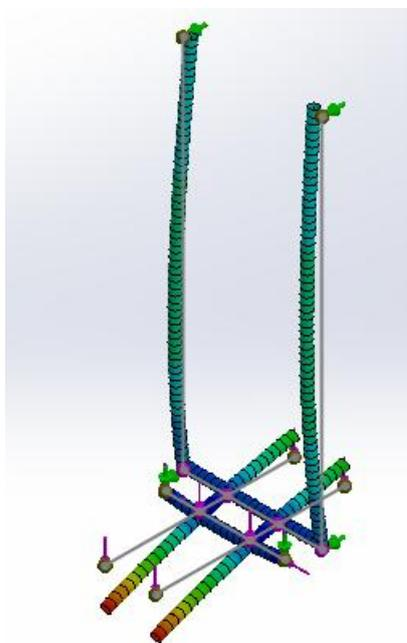
Figura 11: Modelo viga del bastidor.
