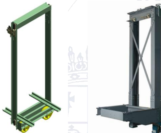
Figura 3: Chasis cabina tipo pórtico (izquierda), tipo mochila (derecha).
