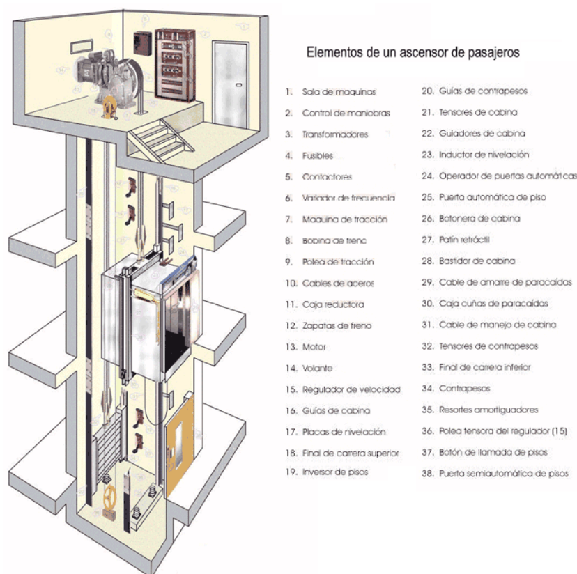
Figura 1: Elementos de un ascensor eléctrico. [1.4]
