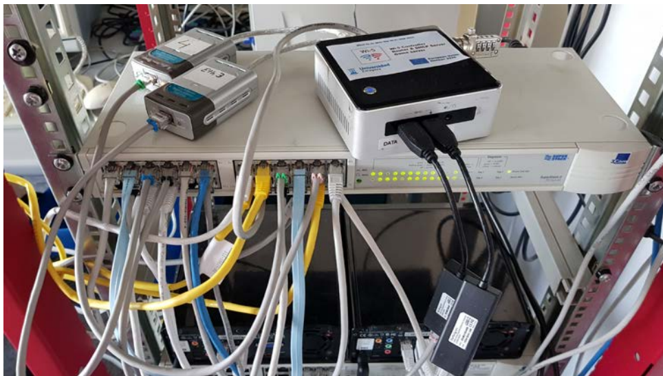
Figura 11. Intel Nuc sobre el concentrador segmentado utilizado para capturar en los diversos planos.
