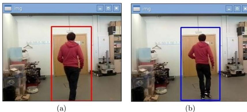
Figura 4.5: El sistema señala el elemento localizado por el algoritmo de detección con un recuadro rojo (a) o con un recuadro azul si ya ha entrado en la fase de *tracking* (b).
