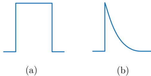
Figura 3.5: Ondas de salida de un generador basado en condensador: (a) Ideal. (b) Worst case .
