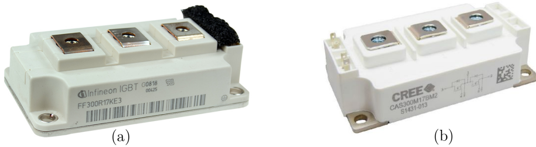
Figura 5.8: Módulos de potencia empleados en los test: (a) IGBT de Si. (b) Módulo de potencia basado en SiC.
