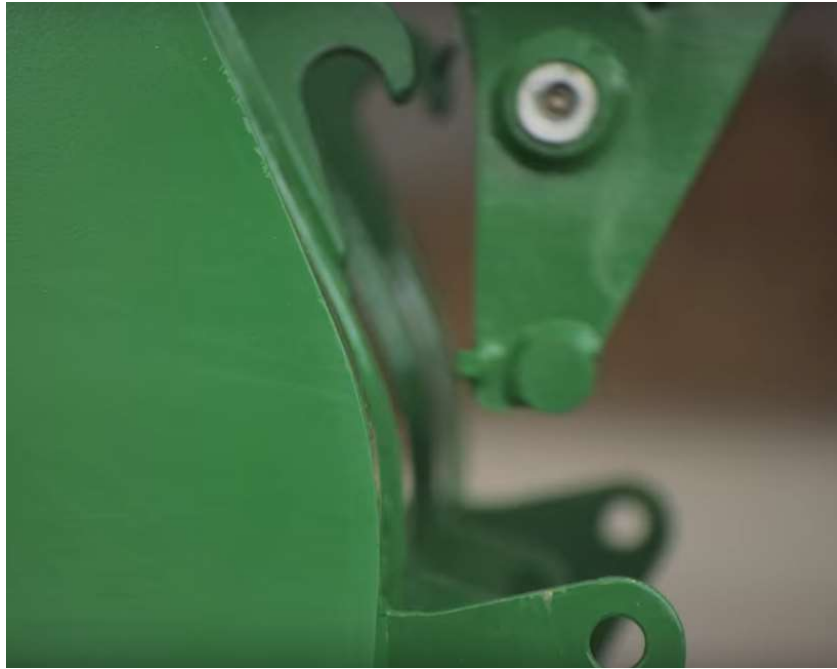
Ilustración 5: Acople cazo - pala
