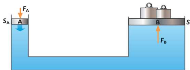
Ilustración 1: Principio de Pascal
