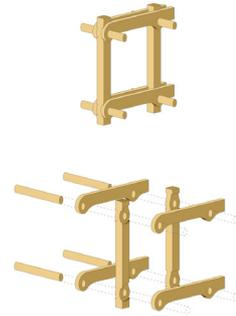
Fig. 4.86. Axonometría unión pilar-viga.
