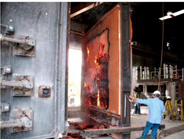
07. Test de resistencia al fuego, Intertek Testing Services NA, Inc. (2006)
