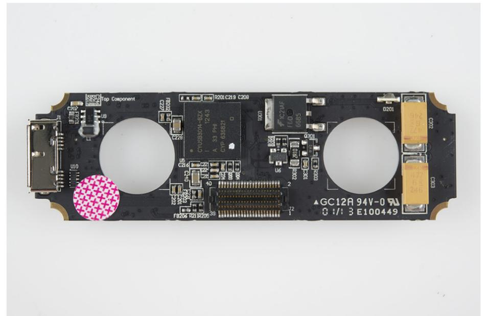
La parte posterior de la PCB superior tiene menos pero más grandes componentes: dos condensadores de tantalio grandes, para proteger contra la fuente de alimentación, un transistor MOSFET para amplificar o conmutar señales electrónicas, un conector de fila doble paso fino a la segunda PCB y los cerebros de la operación.
