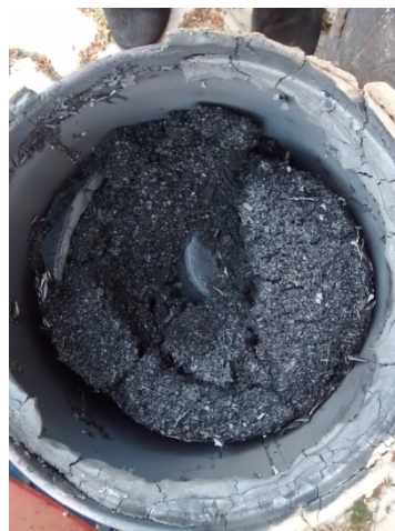
Figura 15. A) Disposición de las piezas B) Resultado de la cocción en atmósfera reductora 36
