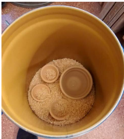
Figura 15. A) Disposición de las piezas B) Resultado de la cocción en atmósfera reductora 36
