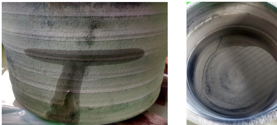
Figura 16. Defectos causados por sobrecalentamiento 38
