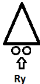
Ilustración 13. Esquema tipo de apoyo usado en los cálculos.
