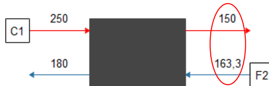
Figura 5 Intercambiador entre las corrientes C1 y F2. Demostración de la violación de la diferencia mínima de temperatura escogida.
