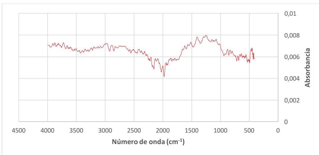
Figura 13. Espectroscopia FTIR del charcoal obtenido a 600 °C
