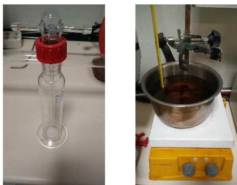
Figura A.3 Borboteador, baño de aceite mineral, termómetro y placa calefactora.
